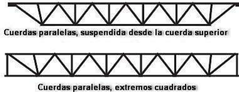
Figura 2-69. Vigas de alma abierta con diferentes tipos de apoyos o extremos
