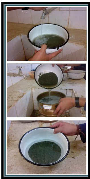
FIGURA. 2.6 Proceso de Lavado de Traducción ASTM C 117-04
