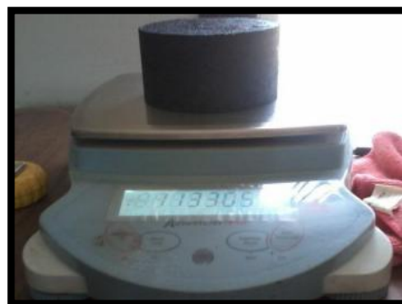
FIGURA 5.11 Obtención de peso Saturado Superficialmente seco.
