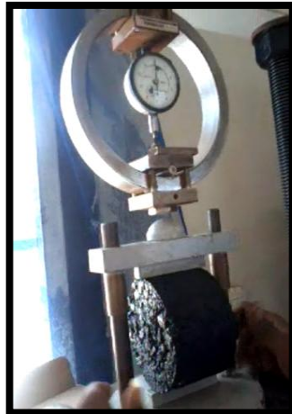
FIGURA 5.16 Ensayo de tracción indirecta de la briqueta.
