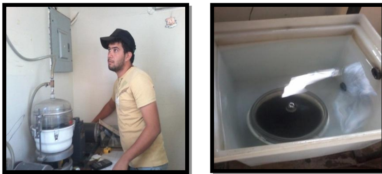
FIGURA 4.10 Proceso de Gravedad Específica Teórica Máxima.
