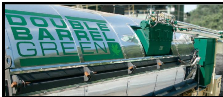
FIGURA. 3.21 Sistema de Asfalto Espumado Integrado a una Planta de Mezcla Asfáltica.
