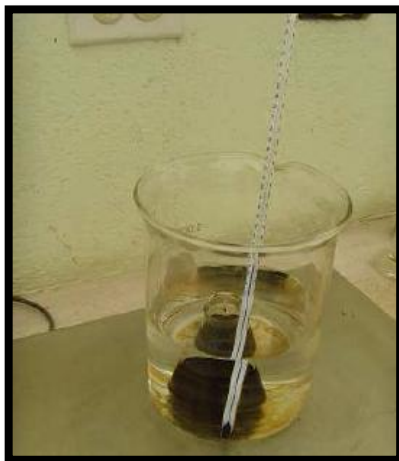
FIGURA 3.5 Baño de agua a 25°C conjunto Picnómetro + asfalto + agua.
