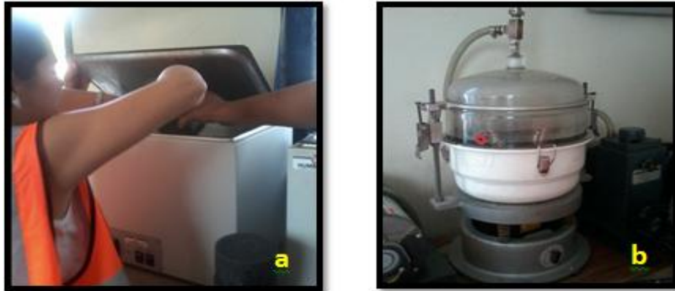
FIGURA 5.15 a) Colocación de briquetas en baño María.
