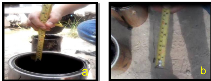
FIGURA 5.4 a) Medición de volumen inicial de asfalto espumado. b) Lectura de volumen final de asfalto espumado.
