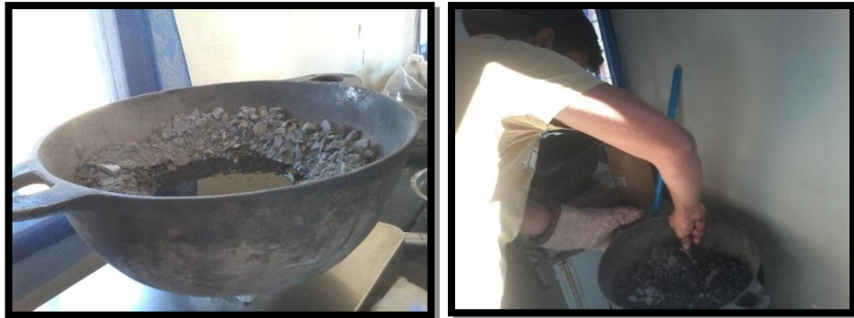
FIGURA 4.3 Proceso de mezclado de los agregados con el asfalto. FUENTE. Planta Asfáltica de constructora DISA S.A. de C.V. Quezaltepeque, Enero 2014.
