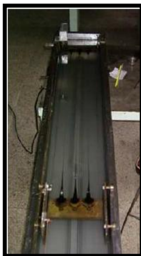
FIGURA 3.8 Muestras Estiradas Antes de que se rompan.
