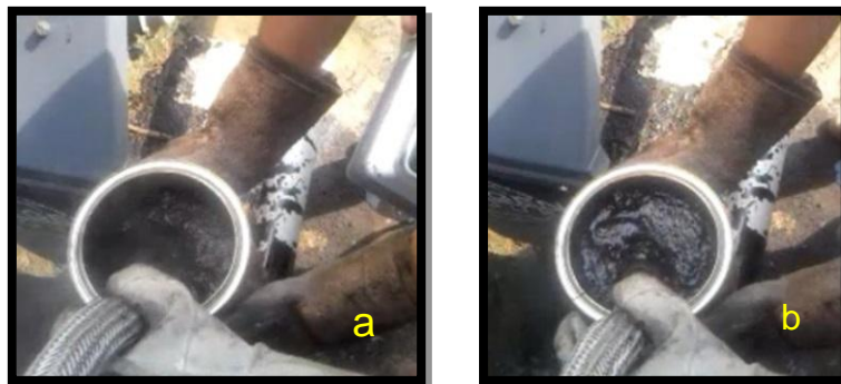
FIGURA 5.2 a) Obtención del asfalto espumado.
