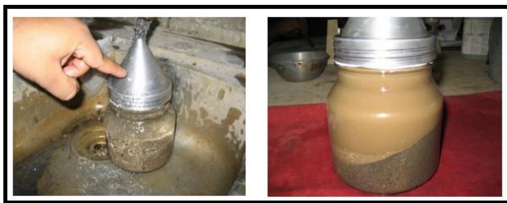
FIGURA. 2.7 Proceso de colocación de arena en el picnómetro
