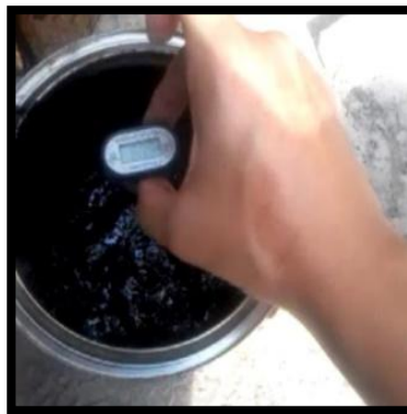
FIGURA 5.3 Toma de temperatura del asfalto espumado.
