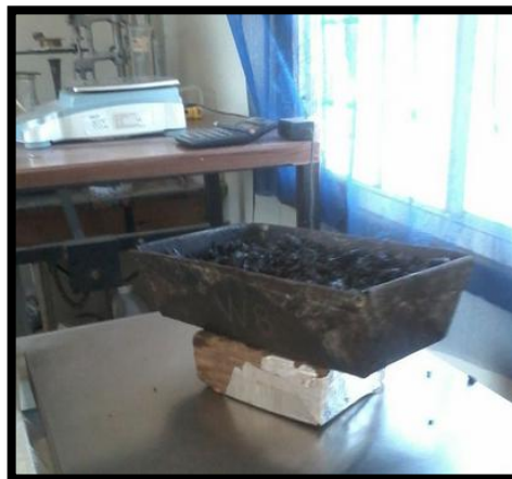
FIGURA 5.7 Pesado de mezcla asfáltica tibia para una briqueta.
