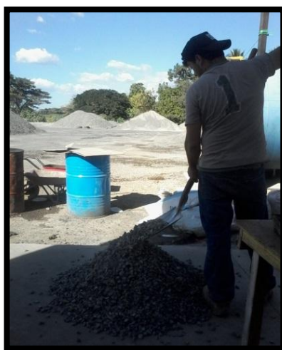
FIGURA. 2.4 Reducción de tamaño de la muestra a través del cuarteo.
