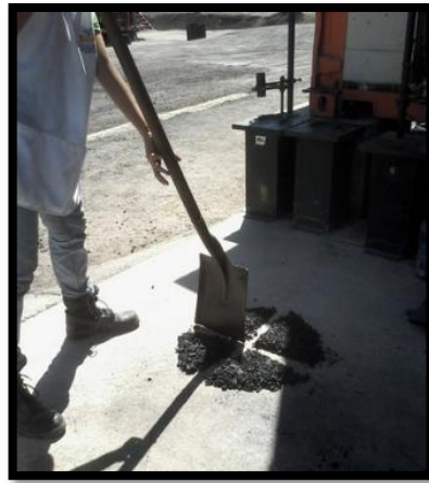
FIGURA 5.6 Cuarteo de mezcla asfáltica tibia.
