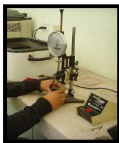
FIGURA 3.6 Penetración en las Muestras.
