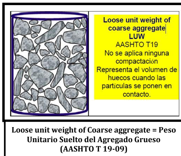
FIGURA. 2.10 Esquema para el Peso Unitario No Compactado del Agregado Grueso (LUW) FUENTE: Miranda L., y otros, "Método de Dosificación Bailey. Aplicación a las Mezclas Stone Mastic Asphalt(SMA)", 2012
