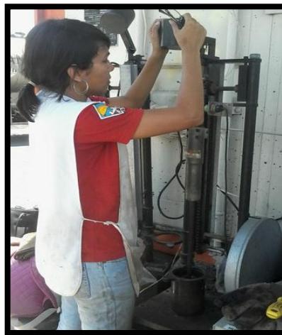
FIGURA 5.9 Compactación de mezcla asfáltica tibia.
