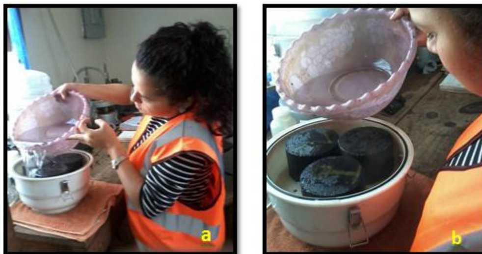
FIGURA 5.14 a) y b) Preparación de especímenes para aplicación de vacíos.
