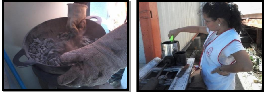
FIGURA 4.2 Proceso de calentar tanto los agregados como el asfalto. FUENTE. Planta Asfáltica de constructora DISA S.A. de C.V. Quezaltepeque, Enero 2014.
