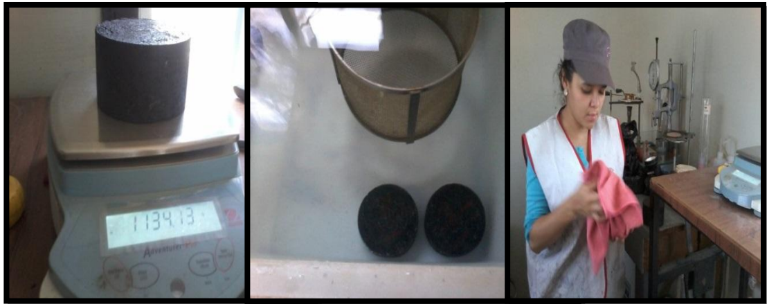
FIGURA 4.9 Proceso de gravedad específica Bulk.
