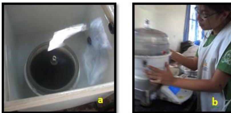
FIGURA 5.13 a) Picnómetro+agua+mezcla sumergido.
