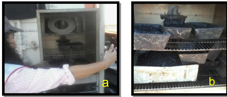
FIGURA 5.8 a) y b) Conservación de temperatura de la mezcla a través de un horno. FUENTE: Laboratorio Planta Asfáltica, Constructora DISA S.A. de C.V., Quezaltepeque.
