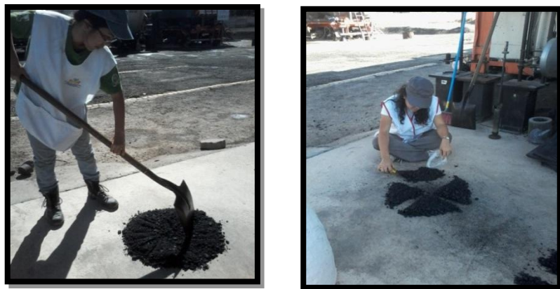
FIGURA 4.4 Cuarteo de la mezcla asfáltica. FUENTE: Planta Asfáltica de constructora DISA S.A. de C.V. Quezaltepeque, Enero 2014.
