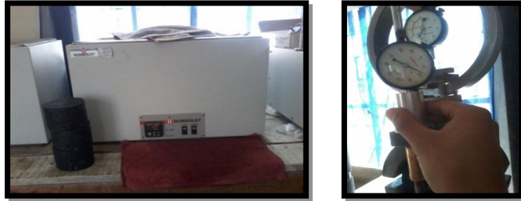
FIGURA 4.11 Ensayo de Estabilidad y Flujo de briquetas.
