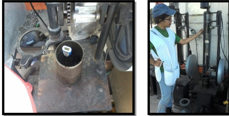
FIGURA 4.7 Proceso de compactación de las briquetas.
