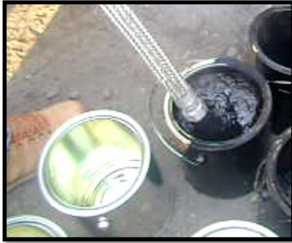
Figura 5.57 Descarga de Asfalto espumado.
