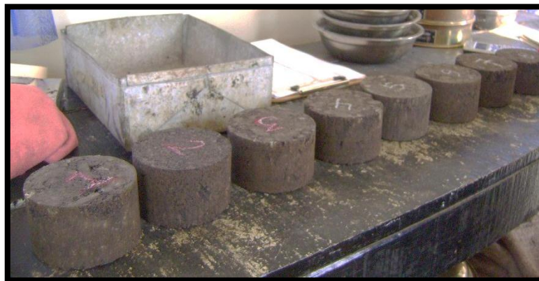
Figura 5.39 Briquetas numeradas ya listas para iniciar el proceso de curado.
