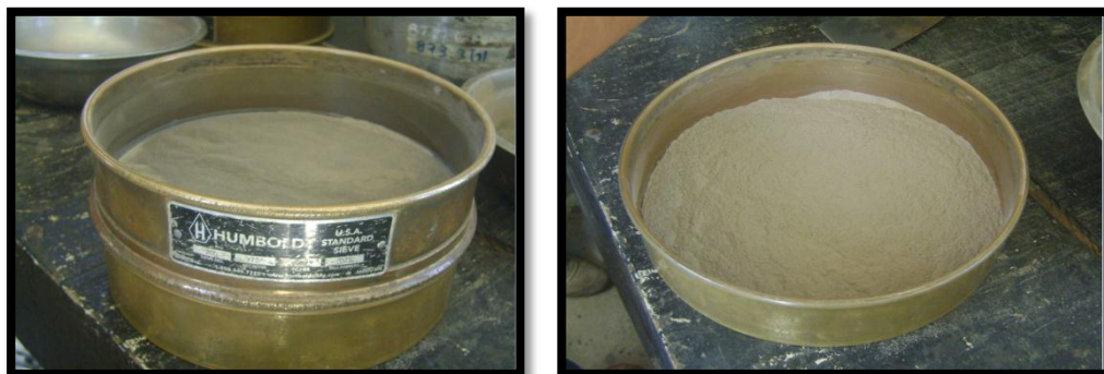
Figuras 5.55 Material fino agregado pasante de la malla N°200.
