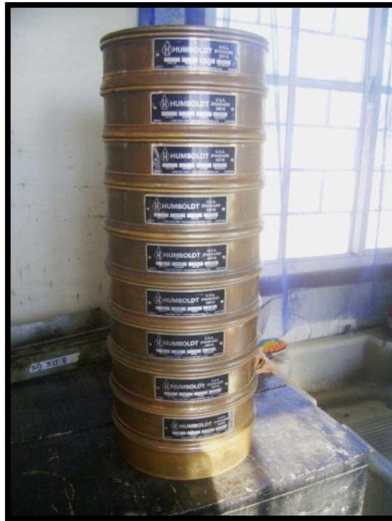
Figuras 5.9 Juego de tamices ordenados en orden decreciente con respecto a su abertura.
