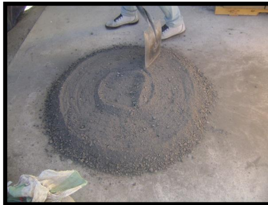
Figuras 5.2 Material aplanado de 4 a 8 veces el espesor del círculo.
