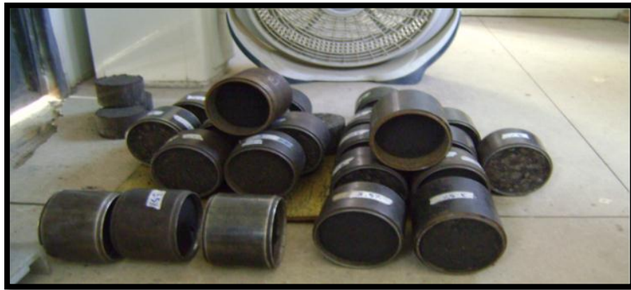
Figura 5.36 Briquetas en el molde por 24 horas.
