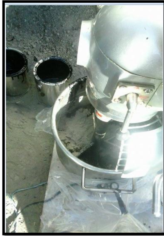
Figura 5.58 1% de cemento en el RAP.
