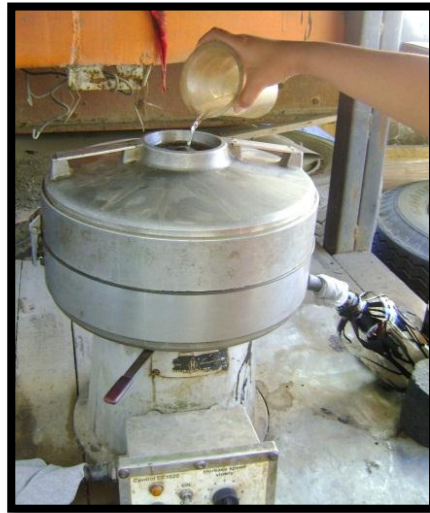
Figuras 5.16 Colocación del químico solvente a material en máquina centrífuga para realizar el ensayo.
