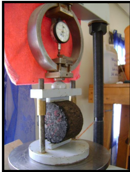
Figura 5.42 Aplicando carga a la briqueta en el ensayo ITS.
