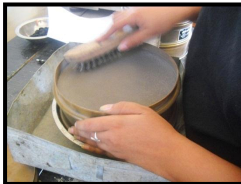
Figuras 5.10 Extracción de material en tamiz.
