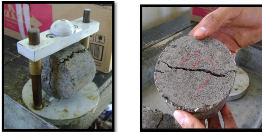
Figuras 5.63 Briquetas en seca después del ensayo ITS.
