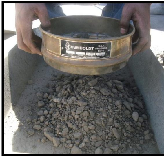
Figura 5.17 Tamizado del material por la malla \frac{3}{4} "
