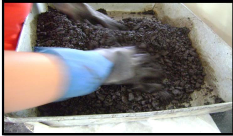
Figura 5.34 Mezclado de R.A.P, agua y Emulsión asfáltica
