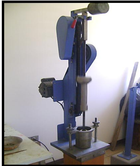
Figura 5.35 Caída libre del martillo Marshall sobre el material en molde cilíndrico. Fotografías tomadas en laboratorio Ing. Mario Ángel Guzmán Urbina de la Facultad de Ingeniería y Arquitectura, UES
