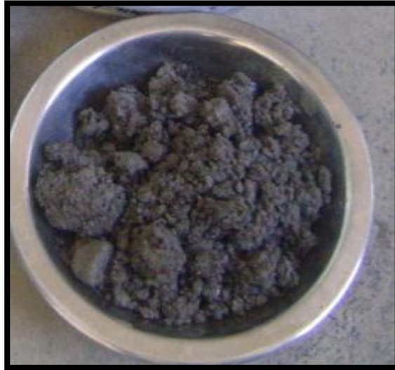
Figura 5.24 Muestra para determinar contenido de humedad tomada de espécimen.
