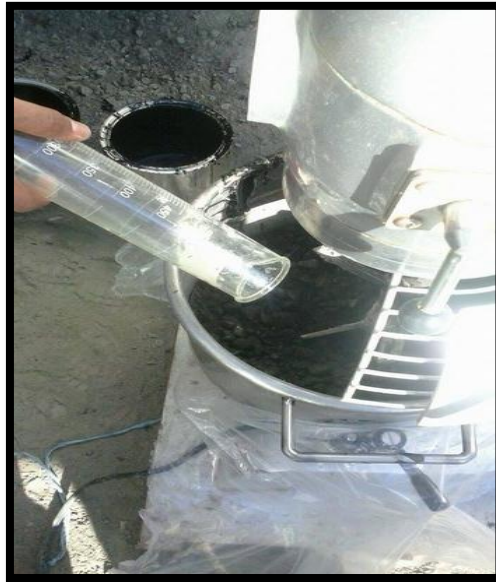
Figura 5.56 Cantidad de agua necesaria a agregar.
