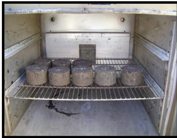
Figura 5.40 Briquetas curándose en el horno por 72 horas.
