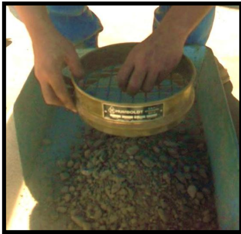
Figuras 5.8 Material tamizado por la malla \frac{3}{4} ".
