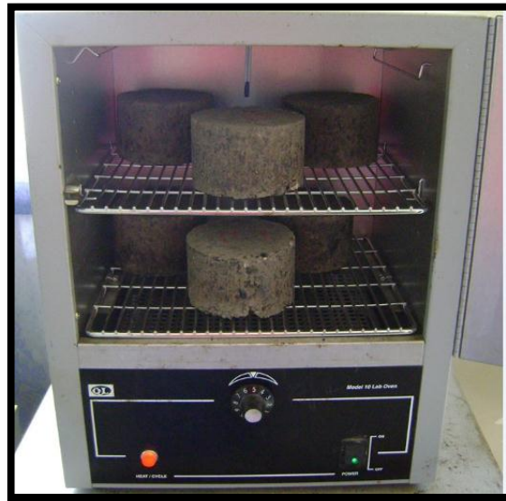
Figura 5.61 Briquetas en curado de 72 h.
