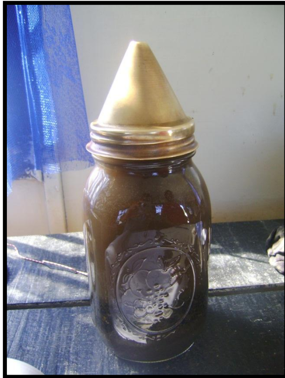
Figuras 5.13 Picnómetro con Agua y material Fino.
