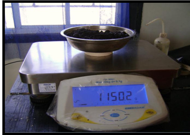
Figura 5.30 Cantidad de masa de material para elaborar briquetas.
