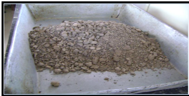
Figura 5.31 Material de carpeta asfáltica fresada.
