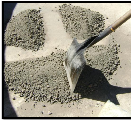
Figuras 5.3 División del material formando cuatro partes iguales.
