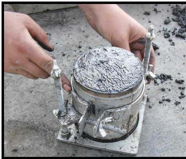
Figura 5.27 Espécimen ya enrasado en el cual se observa la pérdida de agua en el fondo del molde y la superficie abultada por exceso de agua en el material.
