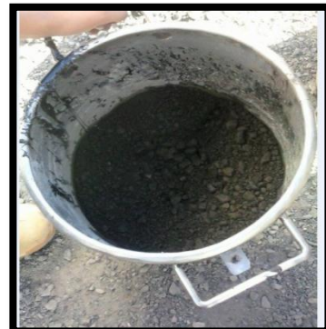
Figuras 5.60. Mezclado del RAP, cemento y asfalto espumado.
