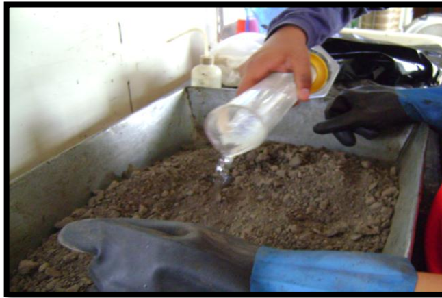
Figura 5.32 Agua a agregar en el material R.A.P
