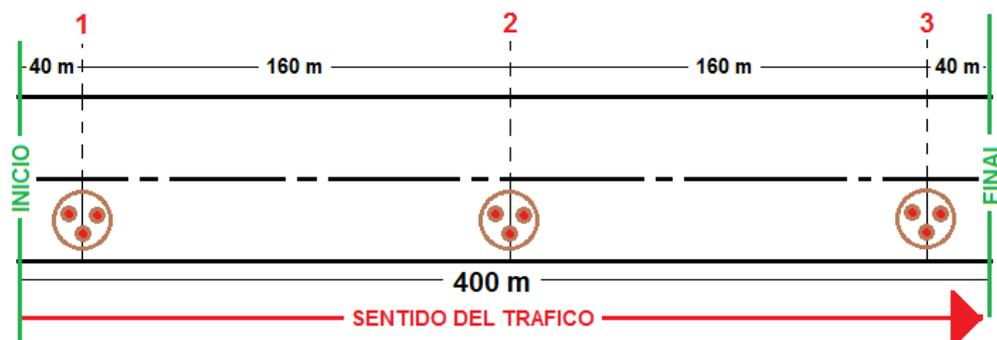
Figura 3-2: Esquema de la distribución de puntos de extracción de núcleos en el Boulevard San Bartolo, Ilopango, San Salvador.
