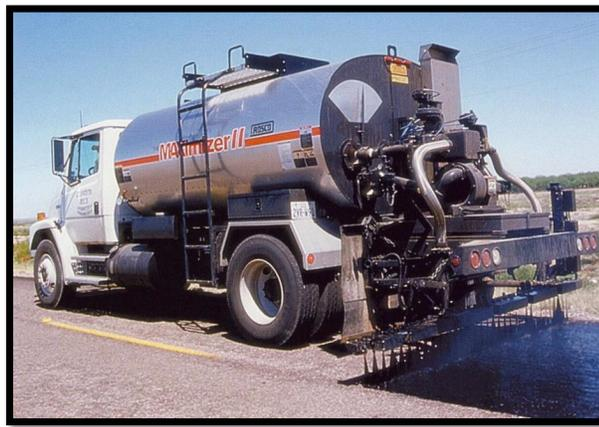
*Figura 2-7: Distribuidor de asfalto*
