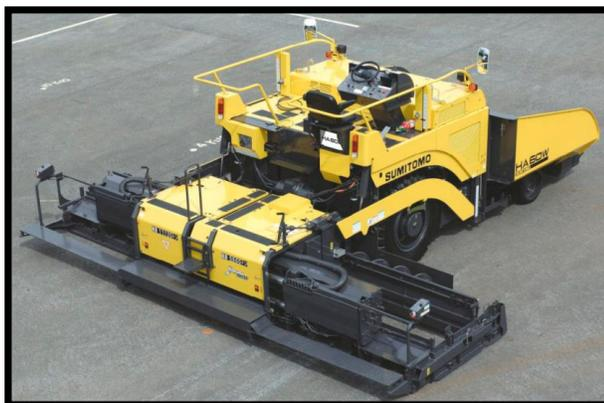
*Figura 2-4: Pavimentadora.*
