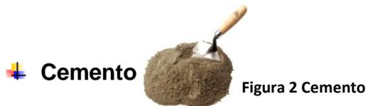
El cemento es un polvo fino que en contacto con el agua, tiene la propiedad de unir firmemente como un pegamento, diversos tipos de materiales de construcción después de endurecido.
