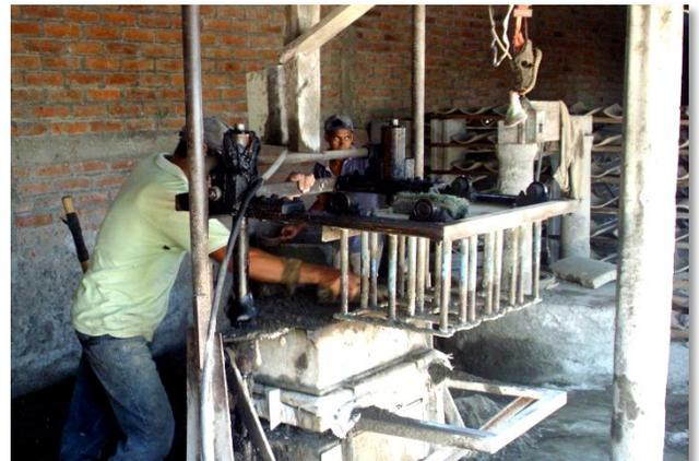
**Figura 70 Retiro de Moldes a manera de no dañar el elemento terminado.**
