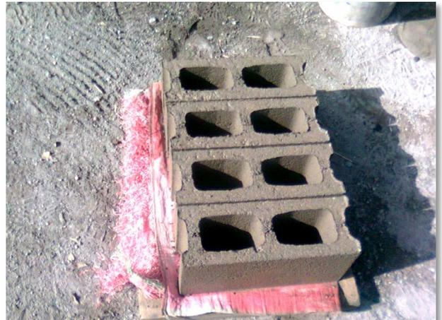
**Figura 71 Bloques colocados a la intemperie en donde reciben calor solar y viento para su secado y endurecimiento**
