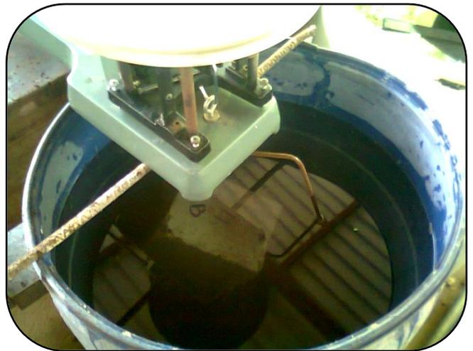
Figura 50 Medición del peso sumergido
