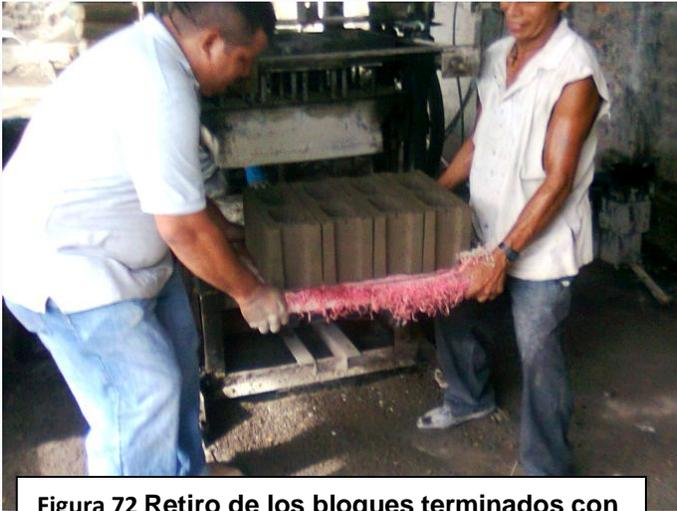
**Figura 72 Retiro de los bloques terminados con sumo cuidado para evitar su deformación**
