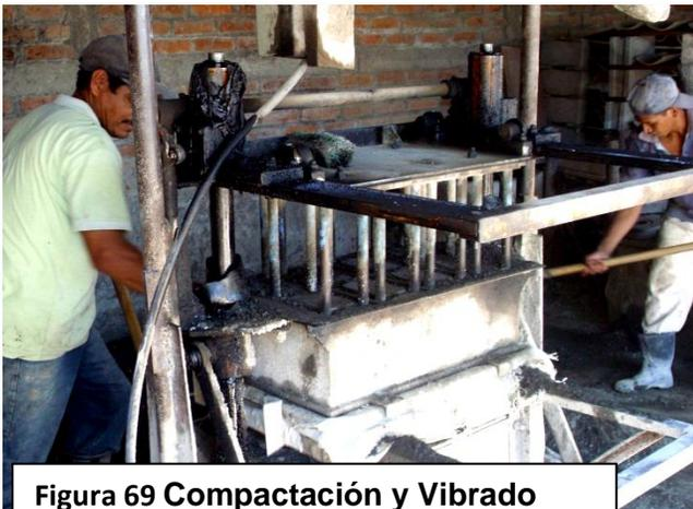
**Figura 69 Compactación y Vibrado durante un corto período de tiempo**
