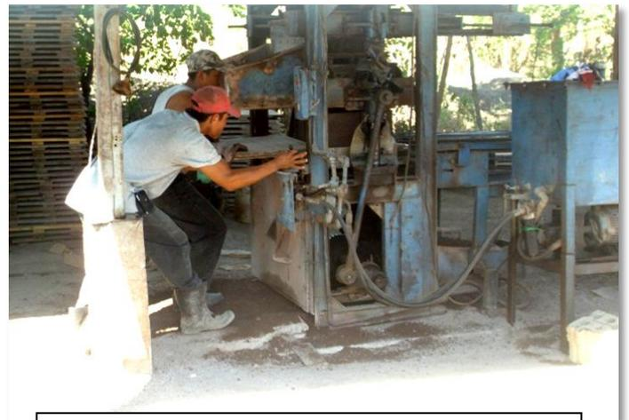
**Figura 66 Colocación de tablas de base** para los bloques.
