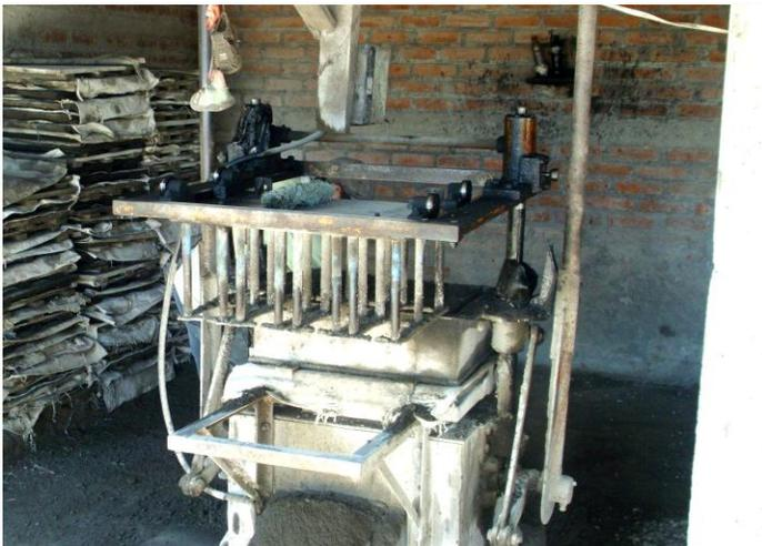
**Figura 65 Máquina Bloquera** en donde se harán los bloques de acuerdo al molde
