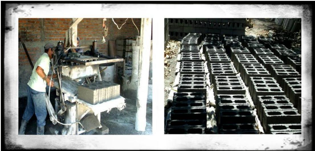
Figura 43 Fabricación de bloques en fábrica El Ingenio
