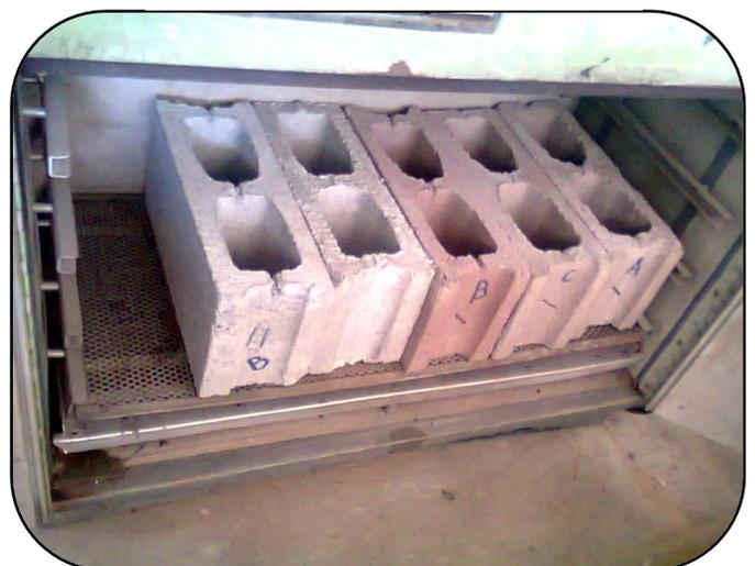
Figura 51 Colocación de bloques en el horno
