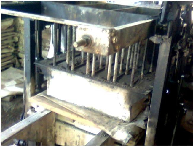
**Figura 67 Colocación y acomodo de los moldes entorno a la mezcla.**
