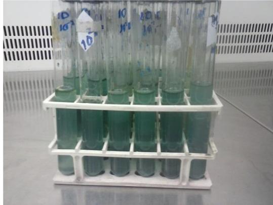
**Figura N° 14.** Determinación de coliformes totales por medio de NMP.
