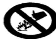
Prohibido apagar con agua
