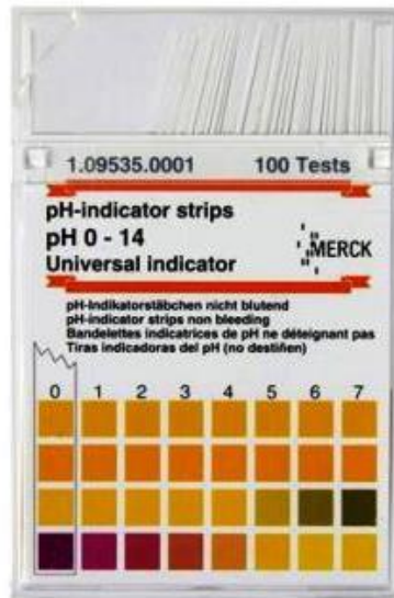
Tiras medidoras de pH con su respectivo patrón de comparación.
