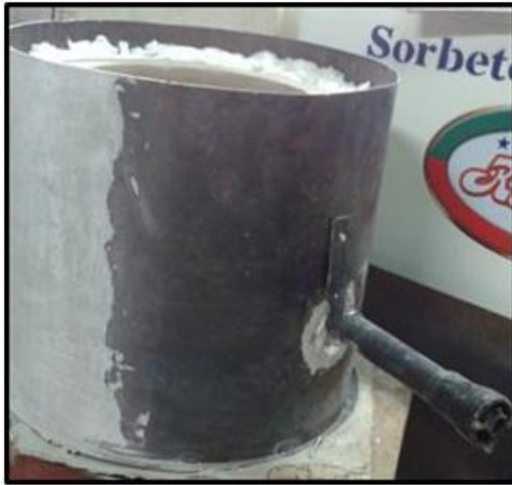
Fig. 3.22 Estructura final de horno antes de la colocación de la tapa.
