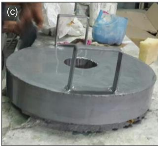
Fig. 3.25. Cubierta o tapa del horno. (a) Fabricación de cubierta para salida de gases del horno, (b) cubierta rellena con fibra cerámica y (c) colocación de agarraderas en cubierta de horno.
