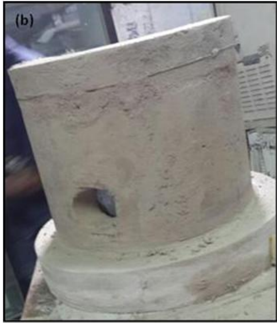
Fig. 3.16. Aplicación de capa de concreto refractario para resanar imperfecciones en las piezas y mejorar el acabado superficial: (a y b) aplicación de mezcla y (c) piezas resanadas.
