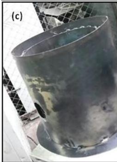
Fig. 3.3. Perforación del orificio para la colocación del quemador: (a) Corte de orificio de quemador, y (b). Orificio en pared exterior de molde (c) Molde finalizado con orificio de quemador.
