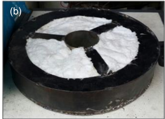
Fig. 3.25. Cubierta o tapa del horno. (a) Fabricación de cubierta para salida de gases del horno, (b) cubierta rellena con fibra cerámica y (c) colocación de agarraderas en cubierta de horno.
