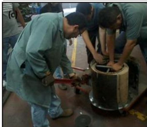
Fig. 3.14. Desmoldeo de paredes de horno: (a) Mediante disco de corte se corta el molde para retirarlo, (b) molde listo para ser retirado y (c) extracción de tubo de orificio para quemador.
