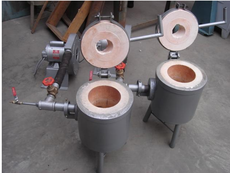
Fig. 1.4. Horno de crisol estacionario. [ http://pe.clasificados.com/venta-de-hornos-para-fundicion-e-insumos-104784 ]
