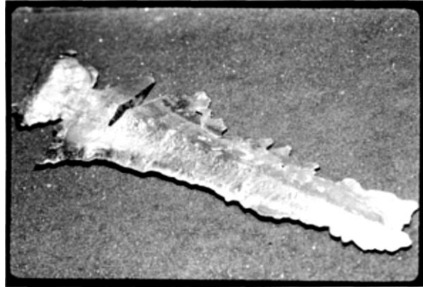
Fig. 1.1. Espada, típica de la edad de bronce, elaborada en cobre arsenical y en molde de dos partes. [ASM Handbook – Vol. 15, Casting].
