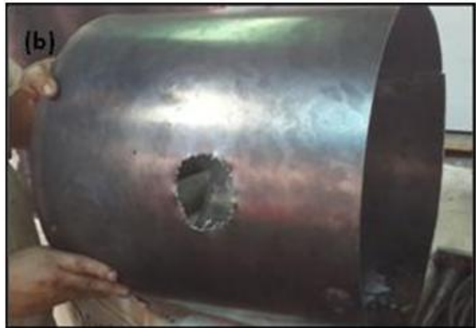
Fig. 3.3. Perforación del orificio para la colocación del quemador: (a) Corte de orificio de quemador, y (b). Orificio en pared exterior de molde (c) Molde finalizado con orificio de quemador.
