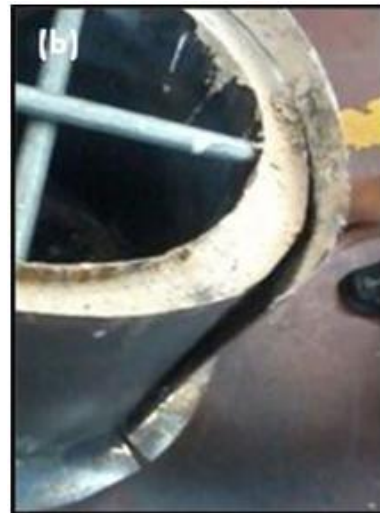
Fig. 3.14. Desmoldeo de paredes de horno: (a) Mediante disco de corte se corta el molde para retirarlo, (b) molde listo para ser retirado y (c) extracción de tubo de orificio para quemador.
