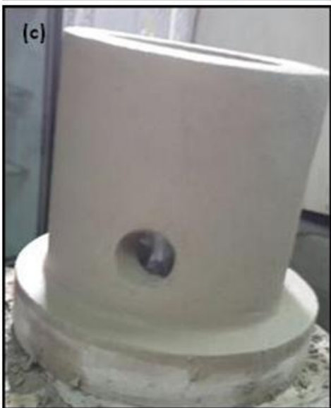
Fig. 3.16. Aplicación de capa de concreto refractario para resanar imperfecciones en las piezas y mejorar el acabado superficial: (a y b) aplicación de mezcla y (c) piezas resanadas.
