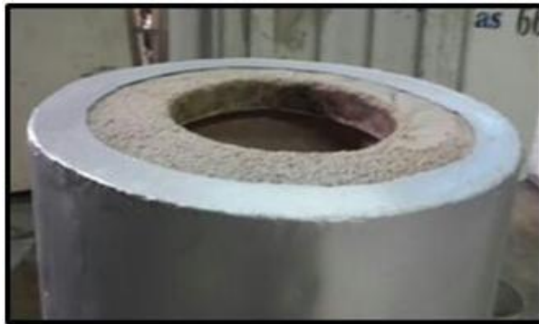
Fig. 3.24. Colocación de pestaña en carcasa de horno para cerrar la estructura.
