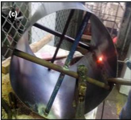
Fig. 3.2. Molde utilizado para el fraguado y vaciado del concreto refractario correspondiente a las paredes del horno: (a) Vista superior de molde, (b) Vista lateral de molde y (c) Colocación de crucetas en el cilindro interior del molde.
