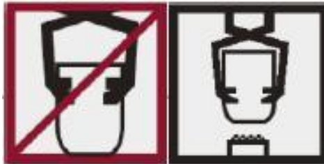
Fig. 1.15. Las pinzas deben encajar perfectamente en el crisol y agarrarlo por la parte inferior [27].
