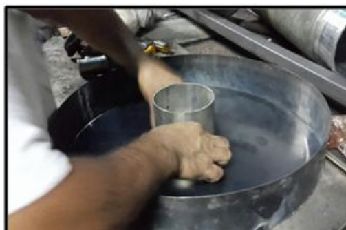
Fig. 3.9. Colocación de tubo para salida de gases.
