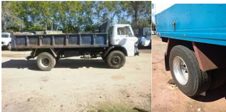
Figura 2.32: Ejes tándem (eje simple con dos ruedas en cada extremo)
