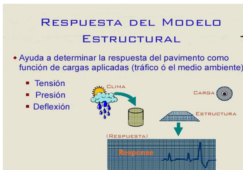
Figura 2.3: Interacción de los datos de entrada y salida del modelo estructural del pavimento.
