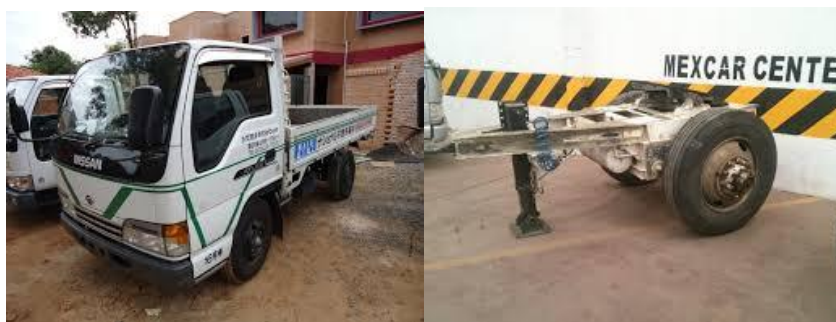
Figura 2.31: Ejes sencillos (una rueda por extremo)
