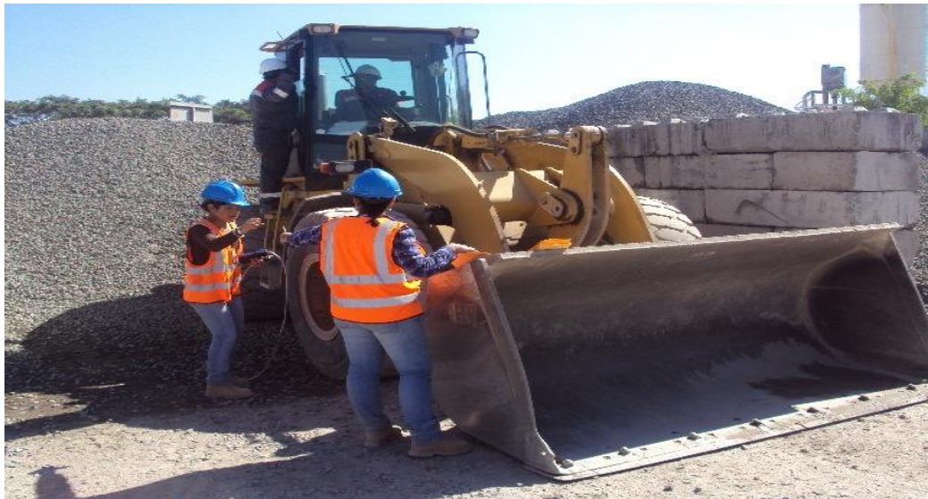
Figura No. 27 Realización de cuantificación de gases en fuentes móvil (camión cargador)
