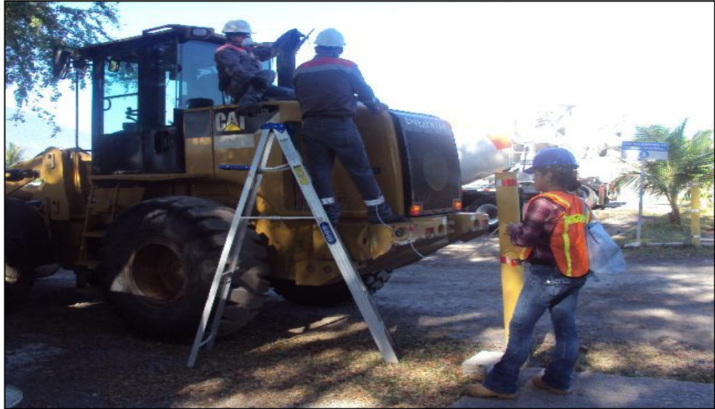
Figura. No.24 Realización de cuantificación de gases en fuentes móvil (Camión cargador)
