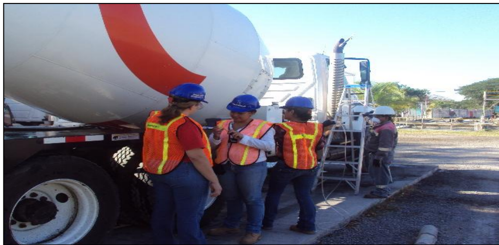
Figura. No.23 Realización supervisada de cuantificación de gases en fuentes móvil (camión mezclador). Plantel San Andrés.
