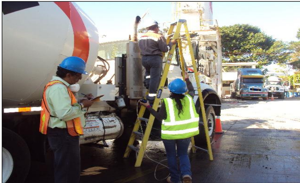
Figura. No.22 Realización supervisada de cuantificación de gases en fuentes móvil (camión mezclador). Plantel Santa Tecla.
