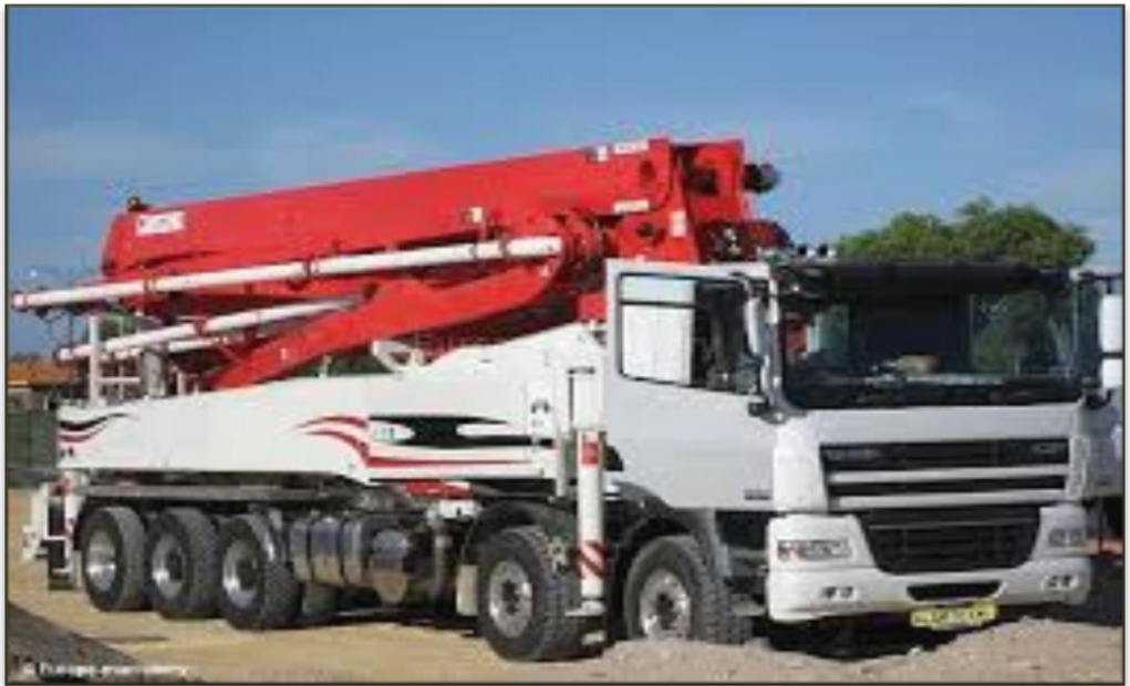
Figura N° 11 Bombas impulsadoras de concreto.
