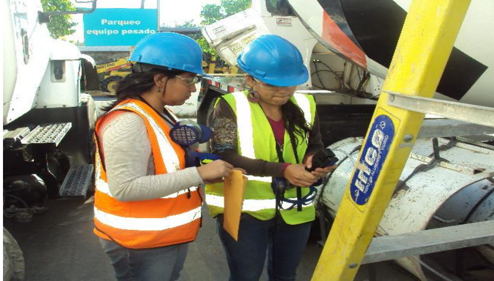
Figura No.28 Realización de cuantificación de gases en fuentes móvil (camión cargador) con EPP completo.
