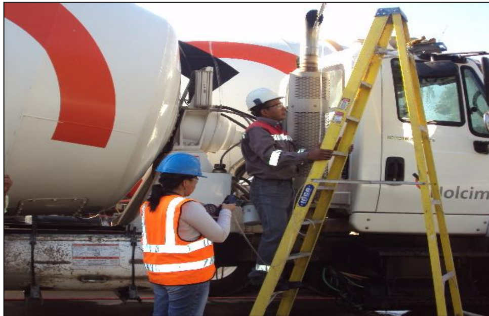
Figura No.21 Realización de cuantificación de gases en fuentes móvil (Camión mezclador)
