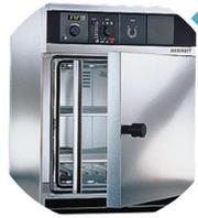
Incubar por  $35^{\circ}\text{C} \pm 0.2^{\circ}\text{C}$  por 24 horas
