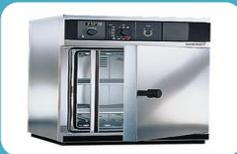
Incubar a una temperatura de  $35^{\circ}\text{C} \pm 0.2^{\circ}\text{C}$  por 24 horas.
