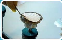
Paramos el sistema de vacío y separamos el embudo de la base del filtro para retirar con pinza estéril la membrana filtrante.
