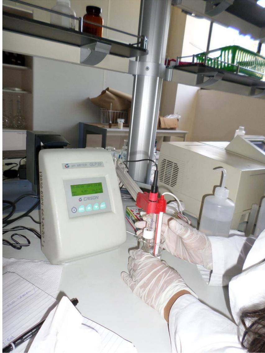
**Figura N°28: Equipo utilizado para medición de pH y Temperatura a las muestras de aguas saborizadas embotelladas**
