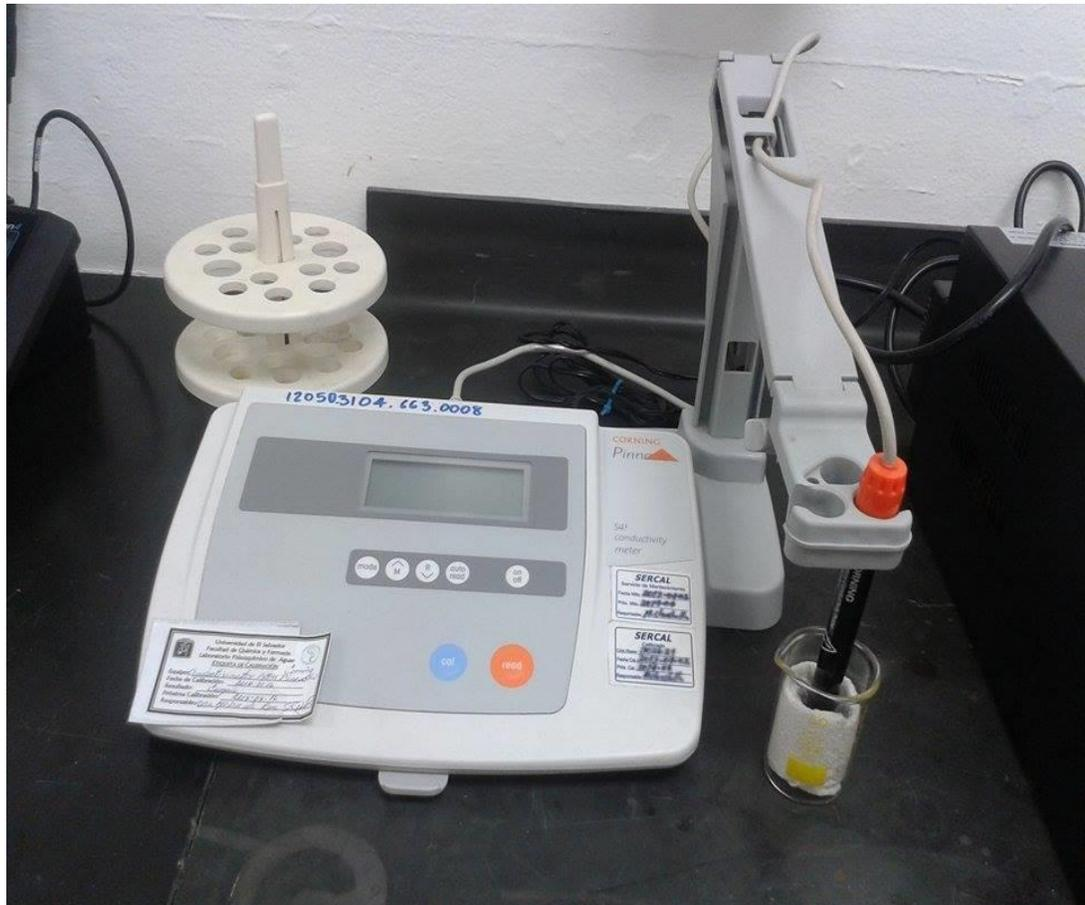
**Figura N°29: Equipo utilizado para medición de Solidos Totales Disueltos a las muestras de aguas saborizadas embotelladas**
