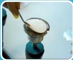
Colocar la membrana filtrante de  $0,45 \mu\text{m}$  de tamaño de poro sobre el porta filtros de las base del mismo.
