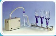
Armar el equipo de filtración y se colocaron 100mL de muestra. Después de filtrar; se realizó un lavado con 100mL de agua peptonada estéril.
