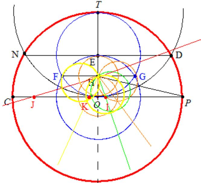
Paso 8. Construir el punto medio del segmento  $\overline{KP}$  y llamarlo  $L$ . Trazar la circunferencia de centro  $L$  y radio  $\overline{LK}$ . Llamar  $M$  al punto de corte de esta circunferencia con el segmento  $\overline{EO}$ .
