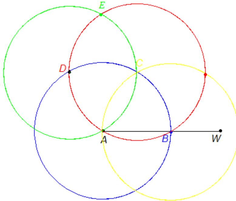
Paso 6: Unir  $E$  con  $A$  y se obtiene una recta perpendicular.
