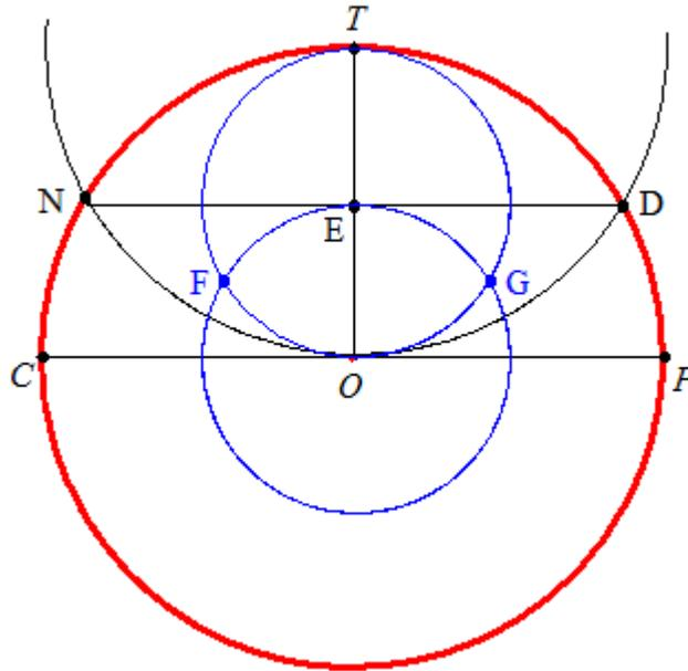
Paso 4. Unir  $F$  y  $G$  marcar con  $H$  el punto de intersección entre  $\overline{FG}$  y  $\overline{TO}$ .
