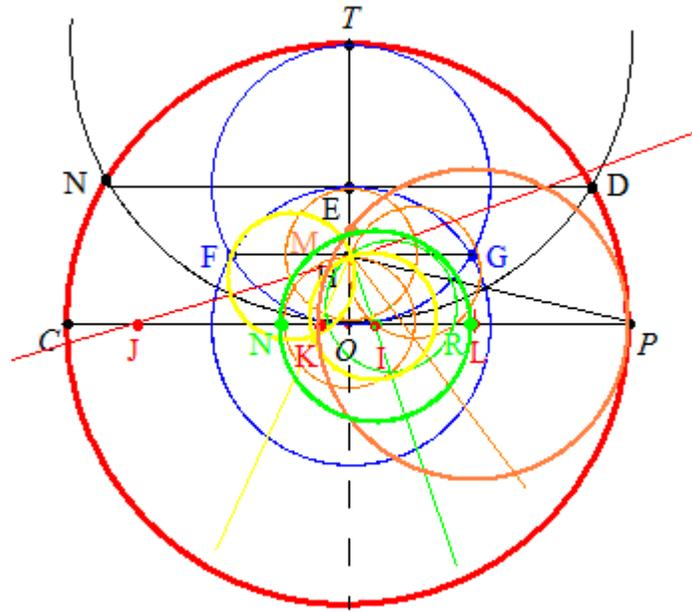
Paso 10. Trazar las perpendiculares al segmento  $\overline{CP}$  que pasan por  $N$  y por  $R$ . Estas perpendiculares cortan a la circunferencia inicial en 1 y 3, que son dos de los vértices del heptadecágono.
