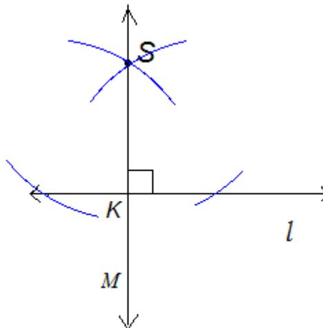
Paso 3: Trazar una recta  $l'$  perpendicular a la recta  $M$  (Constr. 1.3.8) que pase por el punto  $S$ .
