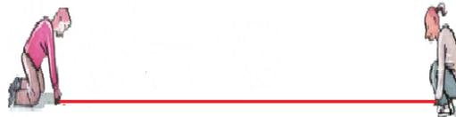
III. A continuación se debe medir de la segunda estaca, 4 metros en forma perpendicular al segmento de recta trazado, colocando en ese punto otra estaca, luego partiendo de la estaca vértice, colocar otra cuerda
