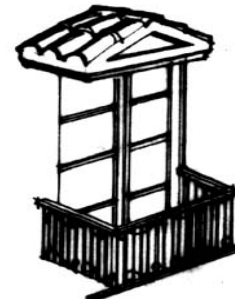
BALCON EN VOLADIZO
