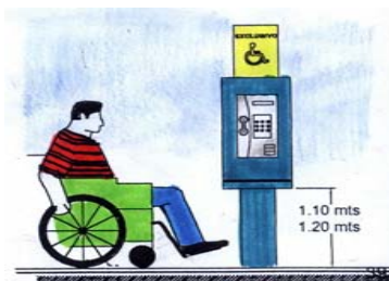
DETALLE No. I DE TELÉFONO ACCESIBLE
