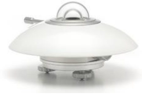
Ilustración 8.- Piranómetro Térmico clase secondary estándar que cumple con la norma Clase ISO 9060.
