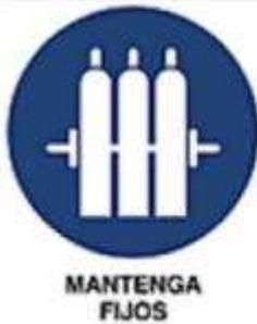
Esta señal indica la obligación de mantener fijos, los tubos de oxígeno, acetileno u otros gases, lo cual se realizará mediante una fijación empotrada a muros resistentes y, además en lugares apropiados. La instalación se realiza en lugares visibles.
