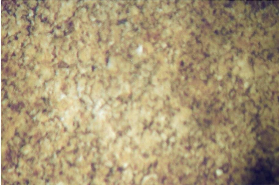
Fig. 5.33. Fotografía a un  $\frac{1}{4}$  del radio desde la superficie en una barra de 2 pulg de diámetro de un acero AISI 1045, a 100x.
