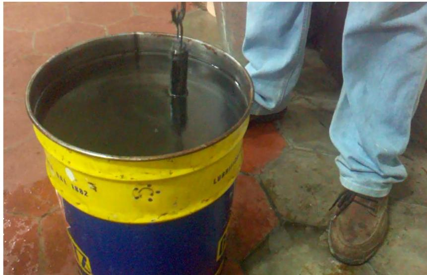
Fig. 4.5. Presenta el momento en el que la barra fue extraída del medio de enfriamiento, se puede observar que su color ha cambiado evidenciando el cambio de temperatura en ese momento cercana a la temperatura ambiente.
