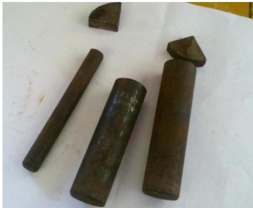
Fig. 4.6. Barras cortadas y dos muestras que serán preparadas para realizar observaciones.
