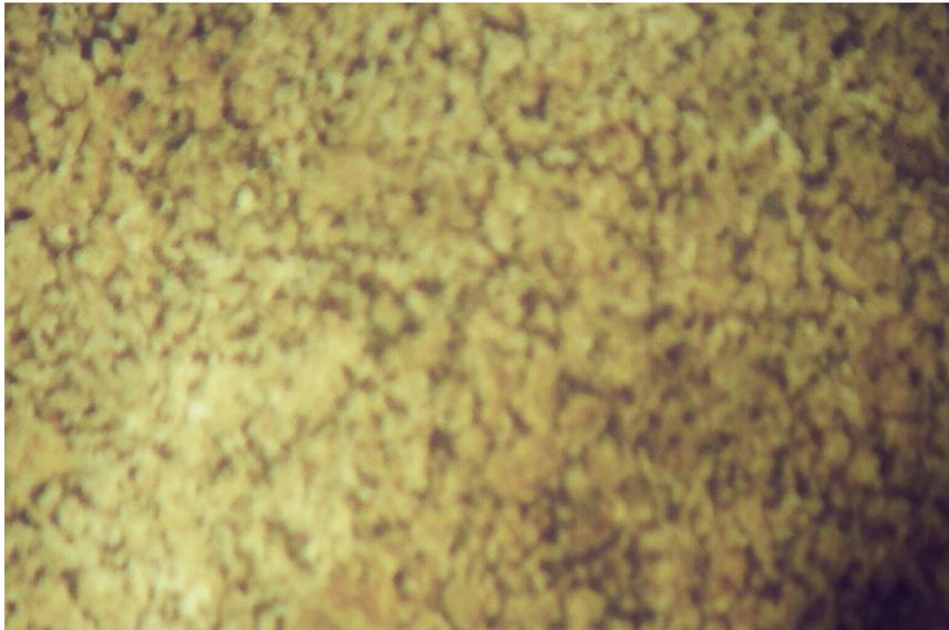
Fig. 5.34. Fotografía a la  $\frac{1}{2}$  del radio en una barra de 2 pulg de diámetro de un acero AISI 1045, a 100x.
