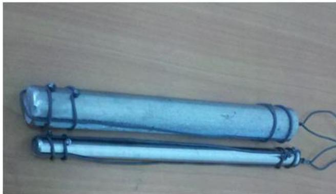
Fig. 4.2. Fotografía de soporte hecho con alambre galvanizado usado para manipular las barras cuando AISI 1045 sacadas del horno a alta temperatura.
