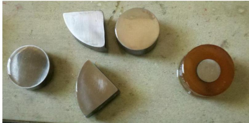
Fig. 4.8. Muestras extraídas de las barras, el brillo de las mismas se debe a que han sido cubiertas con aceite para evitar que se corroan.
