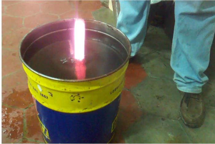
Fig. 4.4. Momento en que se introduce una barra de acero al agua para ser templada.
