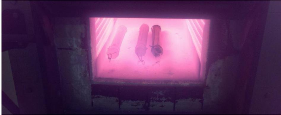
Fig. 4.3. Fotografía tomada mientras se introdujo la última barra de acero de 2 pulg cuando el horno ligeramente por arriba de 850 °C en su intervalo correspondiente, se puede observar que la superficie de la barra que se introdujo primero posee un color idéntico a las paredes del horno, la del medio es un poco más oscura ya que aún no ha alcanzado la misma temperatura y finalmente la que se encuentra más a la derecha apenas comienza su calentamiento.
