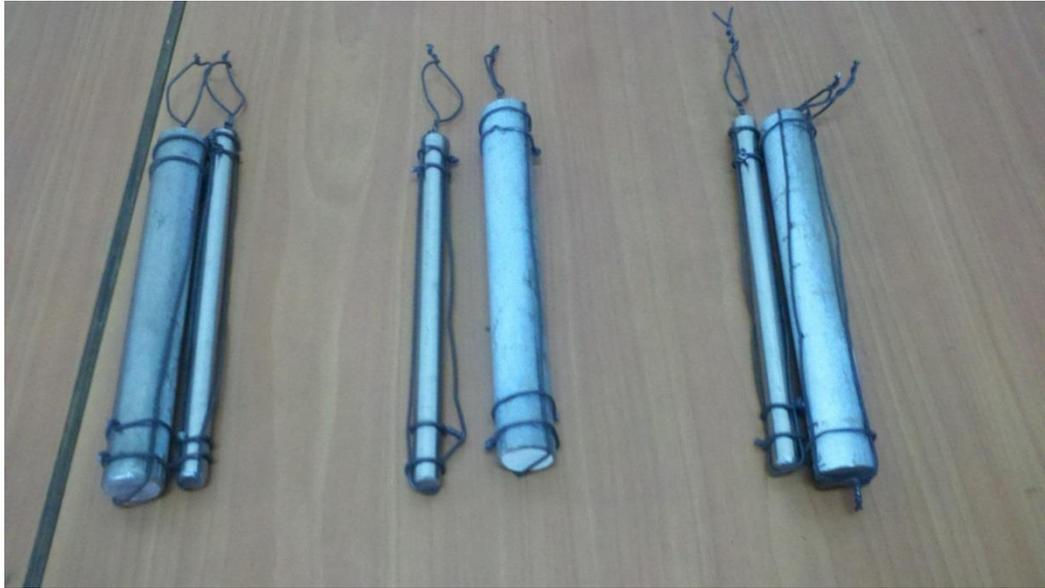
Fig. 4.1. Fotografía de las barras de acero de 1 y ½ pulg antes de ser tratadas térmicamente.
