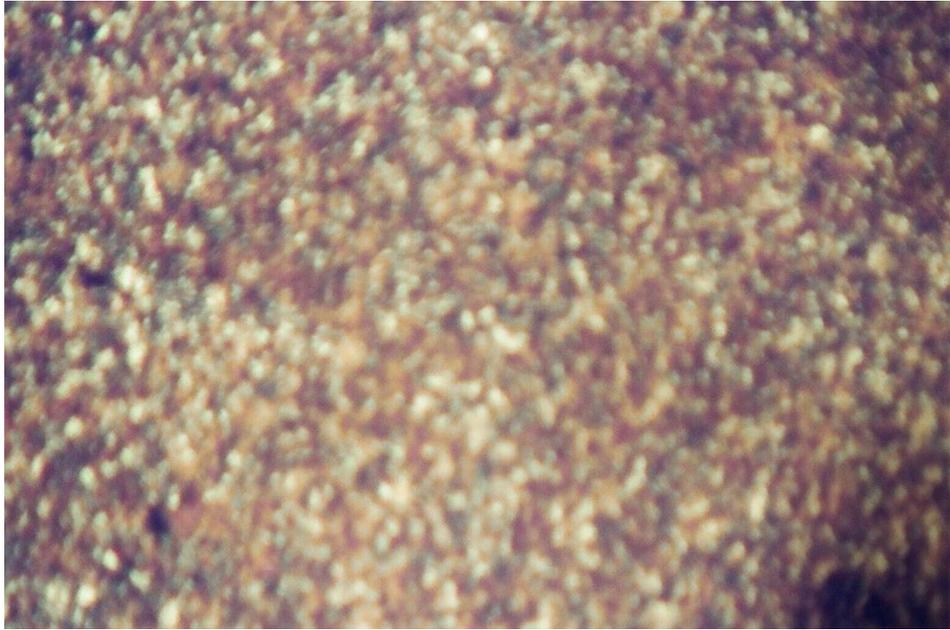
Fig. 5.35. Fotografía del centro de una barra de 2 pulg de diámetro de un acero AISI 1045, a 100 X.
