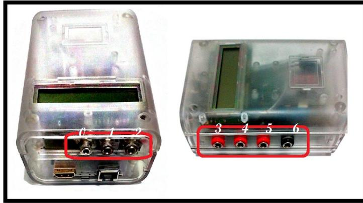
Figura 4.21 Entradas de voltaje-corriente del medidor prototipo.
