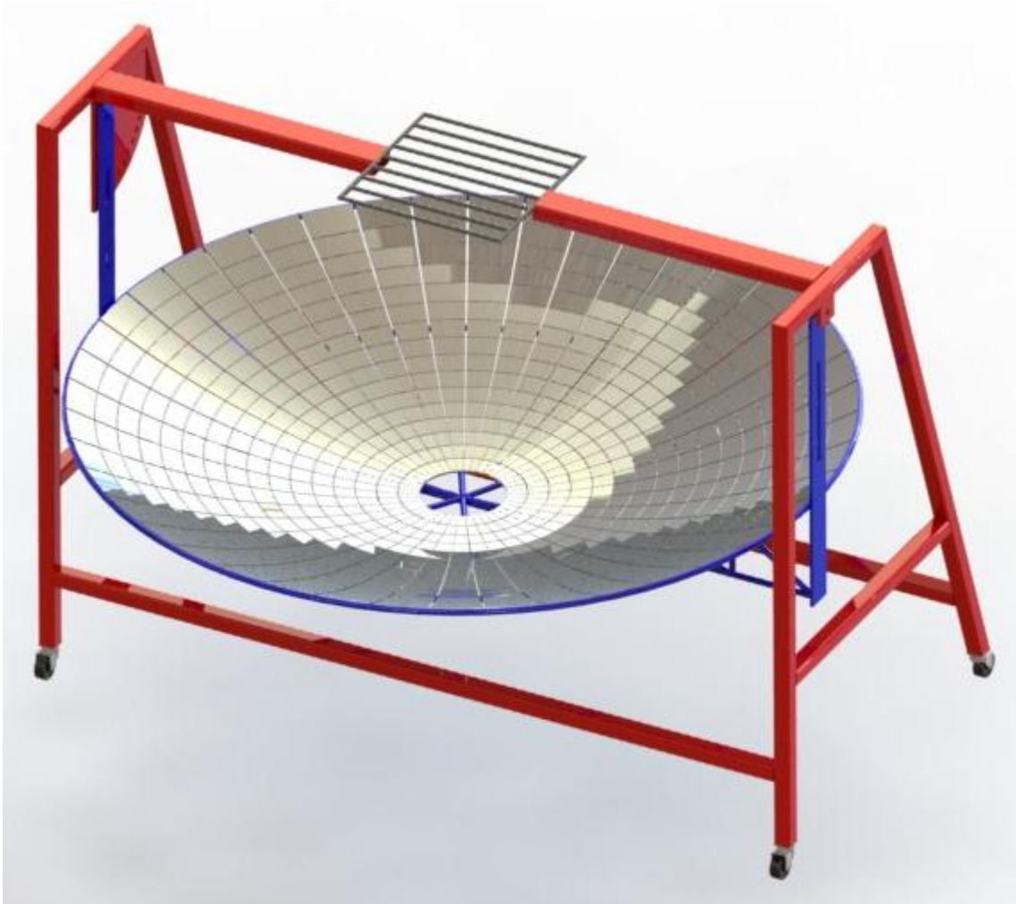
FIG. 2.18 Ensamble de la cocina solar parabólica (rende rizada y dibujada mediante el software solidworks.)
