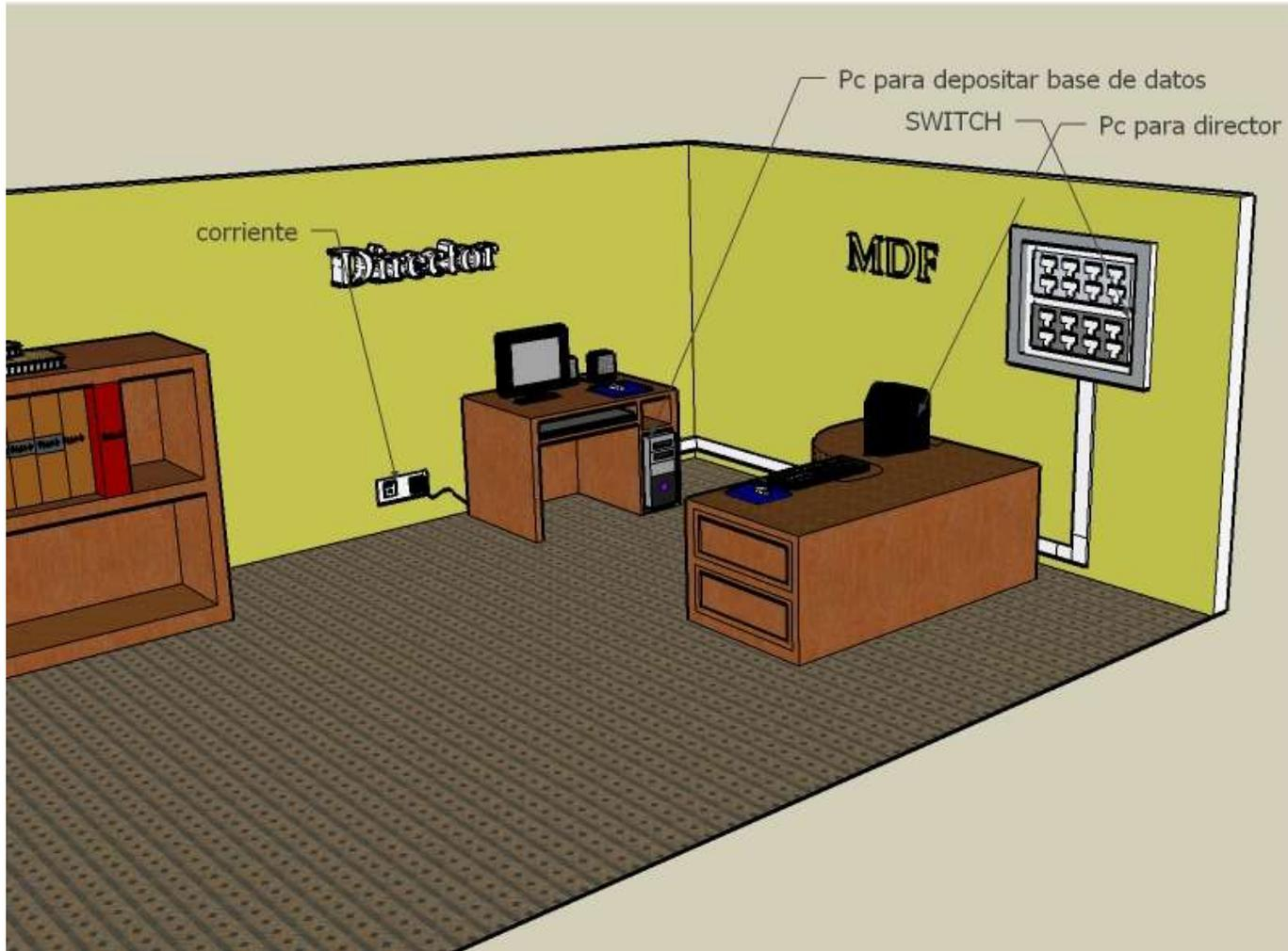
Figura 5.1: Esquema de instalación de MDF.
