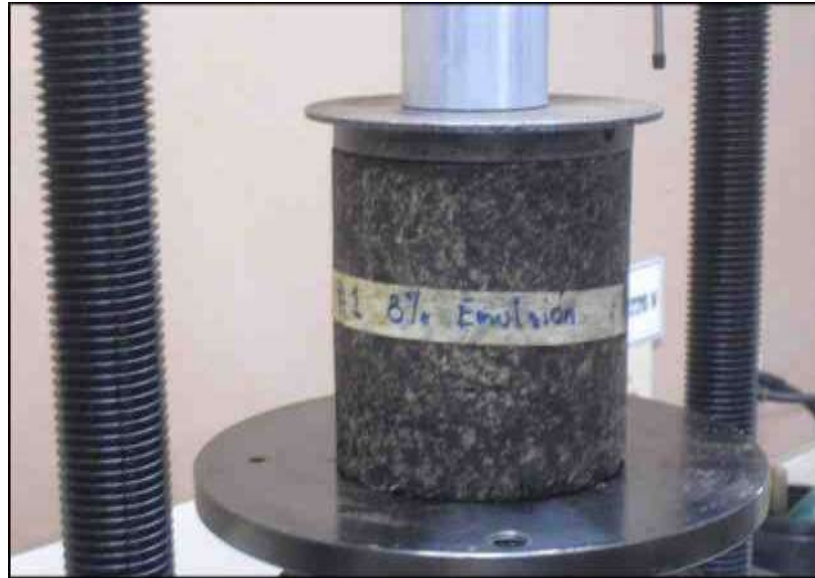
Fig. 3-24: ensayo de compresión en estado satura parcialmente
