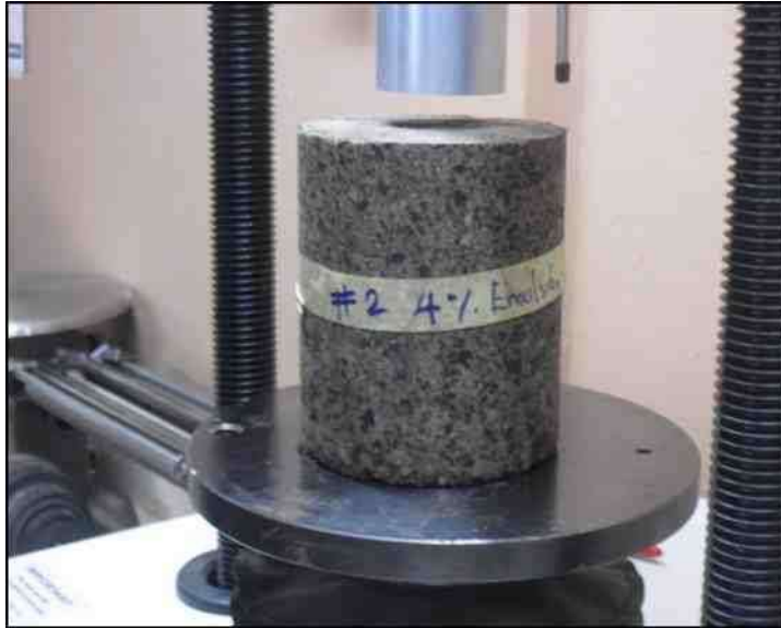
Fig. 3-22: ensayo de compresión en estado seco
