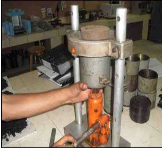
Fig. 3-19: Extracción de Briquetas
