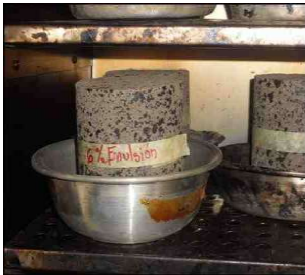
Fig. 3-21: Briquetas en el horno
