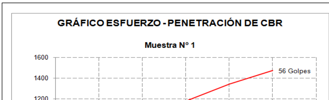
Formato 3-13: Prueba de CBR, SAE con 4% de Emulsión, Muestra N° 1
