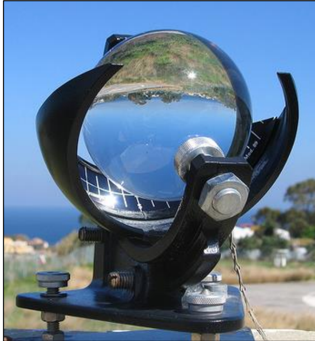
Figura 1.1.9 – Heliofanógrafo o heliógrafo tipo Campbell Stokes.
