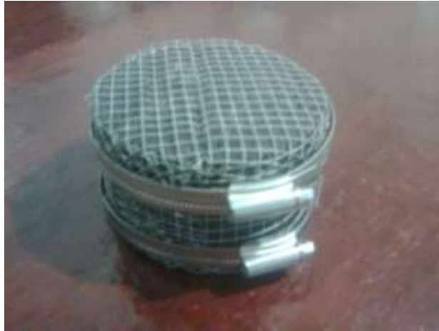
Fotografía 4.20 Mecanismo de sujeción y confinamiento para realizar el ensayo de envejecimiento.
