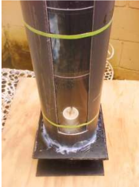
Fotografía 4.22 Permeámetro LCS hecho a mano.
