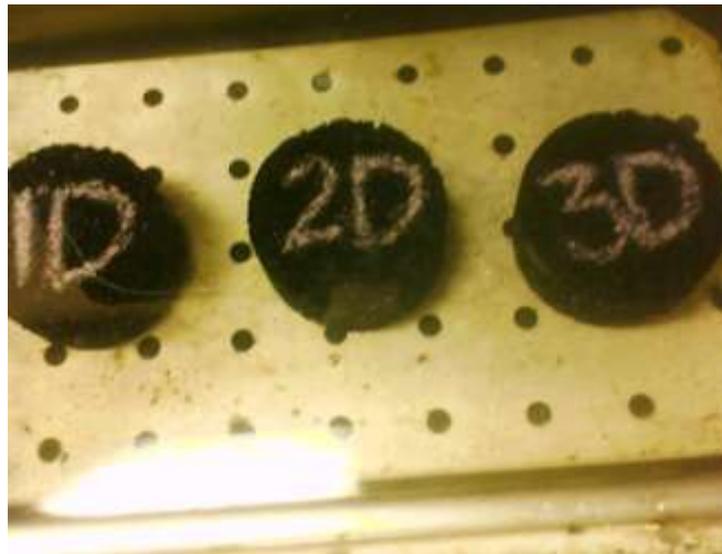
Fotografía 4.18. Briquetas sumergidas en baño de maría a 60°C.
