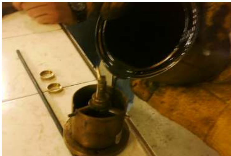
Fotografía 4.4. Vertido de asfalto en el cilindro metálico para recuperación elástica.
