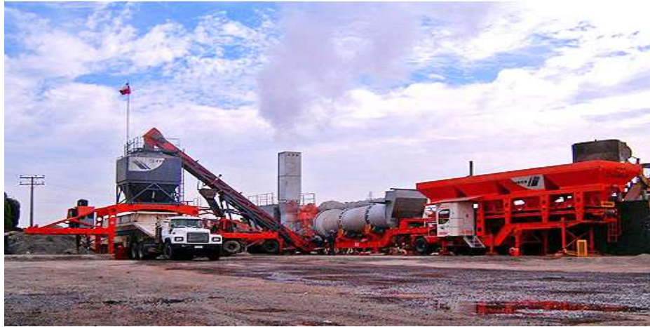
Fotografía 2.3 Planta Asfáltica de secado a contra flujo 20 .
