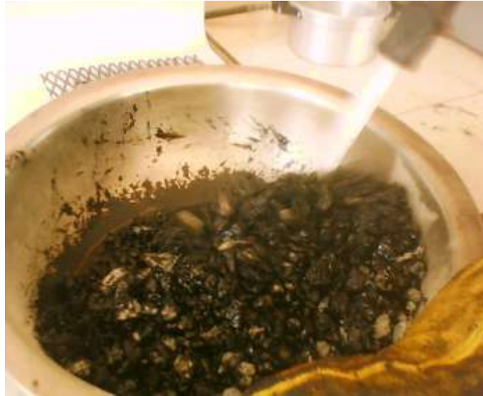
Fotografía 4.6. Mezclado del asfalto con el pétreo.
