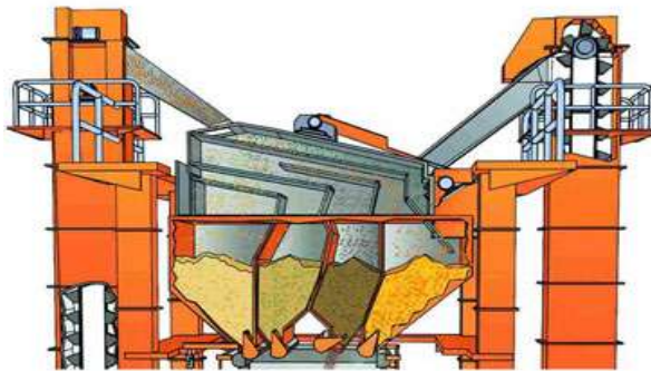
Fotografía 2.2. Planta asfáltica discontinua 19 .
