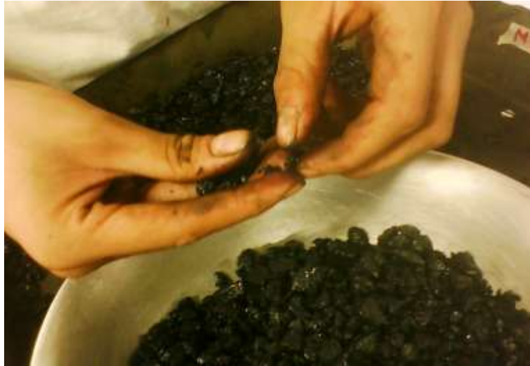
Fotografía 4.11 Desmenuzando de partículas de asfalto.
