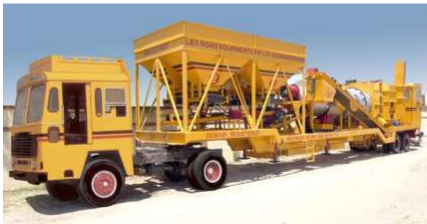
Fotografía 2.5. Planta asfáltica tipo drum-mix 22 .
