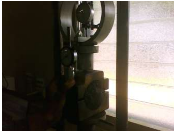
Fotografía 5.1 Biqueta tipo Marshall sometida a deformación.
