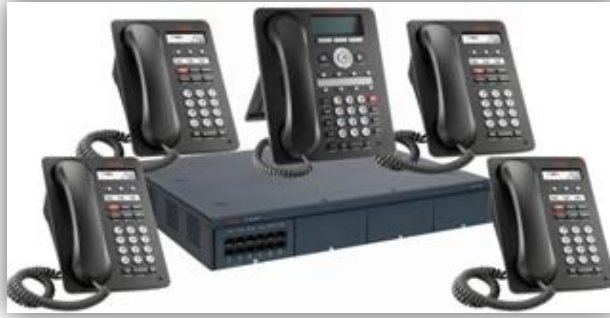
Figura 29. Centralita Avaya IP Office 500 V2 es una central modular híbrida que soporta telefonía tradicional analógica, telefonía digital RDSI y telefonía IP utilizando los 2 estándares del mercado más extendidos, H323 y SIP. [27]
