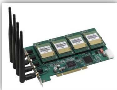
Figura 217. Tarjeta PCI VoIP GSM.
