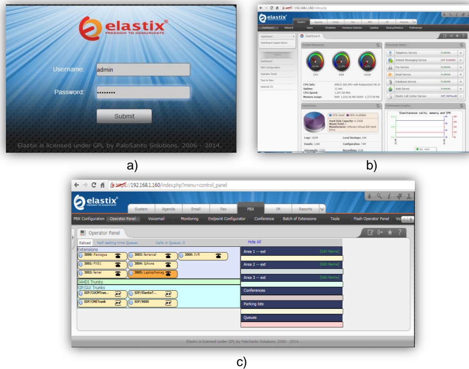
Figura 27. Interfaz Web de planta telefónica IP Elastix. a) Pantalla de bienvenida para ingresar credenciales, b) monitoreo de uso de la planta telefónica así como de sus recursos y c) panel operador. [26]
