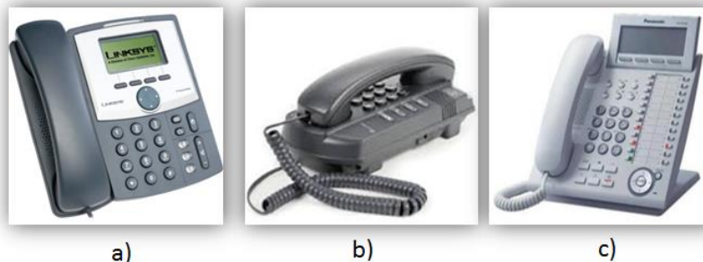
Figura 18. Teléfonos IP utilizados por plantas telefónicas IP. a) Linksys SPA921 [12], b) Teléfono IP Cisco SPA 301 un modelo básico con las funcionalidades de un teléfono análogo [13] y c) Teléfono IP gama alta Panasonic KX-DT346SP [14]
