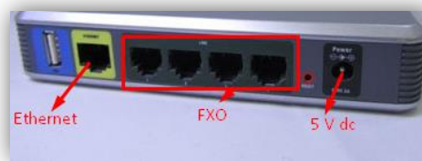
Figura 199. Puertos Módulo Linksys SPA400.
