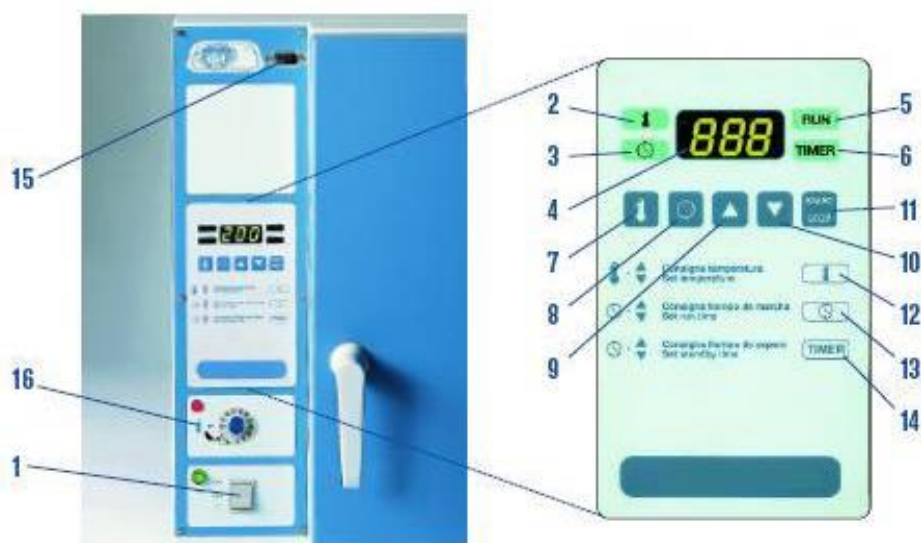
Figura N°1: Panel de mando de la estufa.
