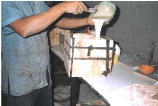
Fig. 4-10 Confección de caja y aplicación de casmaster.
