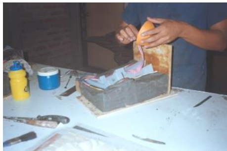
Fig. 4-7A Aplicación de primeras capas de caucho.
