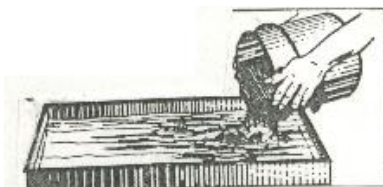
2. Cubierto con reglas de madera por los lados se vierte yeso, para poder confeccionar el molde. Fig. 2-9
