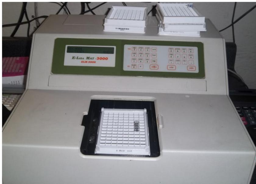
**FIGURA N° 10. Lector de microplacas.**
