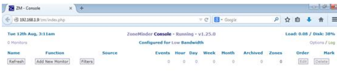
Figura 87. Consola principal del servidor ZoneMinder desde un cliente web.
