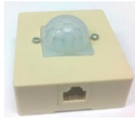
Figura 112. Sensor PIR montado sobre caja modular telefónica.
