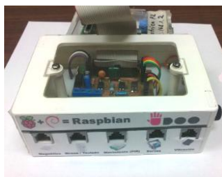
Figura 110. Punto de control compuesto por caja plástica, acrílico, tarjeta electrónica PCB y puertos RJ11.
