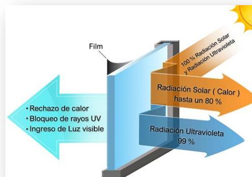
**Figura 12:** Función de la lamina solar. [11]
