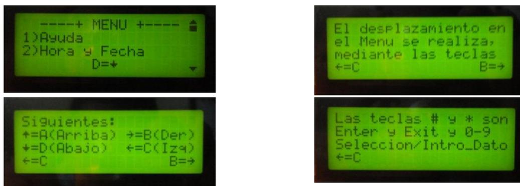
**Figura 4.20.** imágenes del menu ayuda, donde se observa que los desplazamientos de izquierda a derecha se realizan mediante las teclas C y B.
