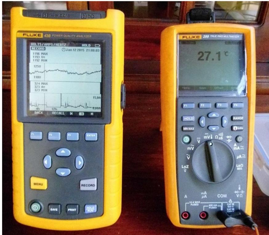
Figura 3.12. Analizador FLUKE 43B y Multímetro FLUKE 289 utilizados.
