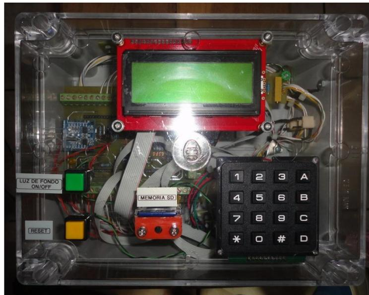
**Figura 4.19.** Vista frontal del sistema de adquisicion de datos construido.
