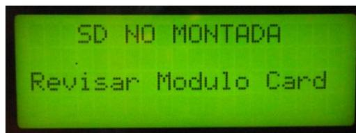
**Figura 4.34.** Mensaje de error por falta o mal montaje de memoria SD en la ranura del modulo Card.
