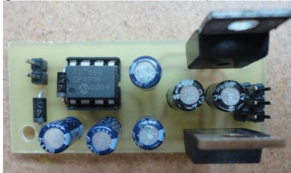
**Figura 4.4.** Circuito de fuente bipolar construida a partir de convertidor TC7660.
