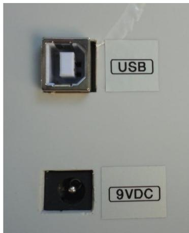
**Figura 4.18.** Puerto de Comunicación serial USB tipo B y entrada de alimentación con centro positivo del sistema de adquisición de datos.
