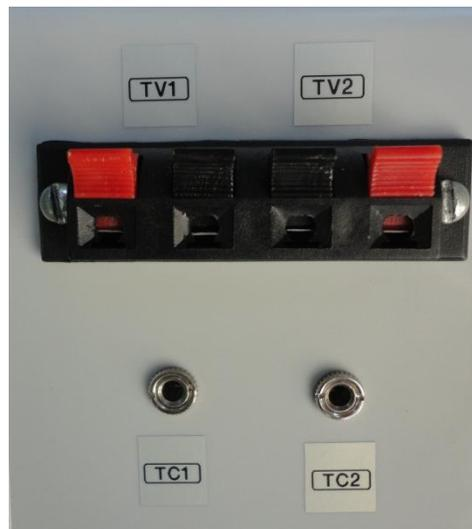
**Figura 4.17.** Borneras de conexión para sensores de voltaje (Transformadores reductores TV1 y TV2) y Jack para conexión de transformadores de corriente TC1 y TC2.
