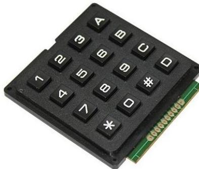
**Figura 2.44.** Teclado Matricial de 4 filas y 4 columnas [29].
