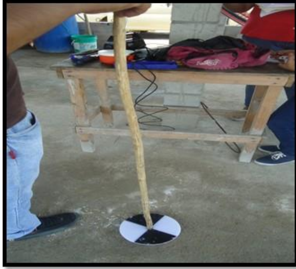
Ilustración 59 Instrumento para medir la Turbidez del agua.
