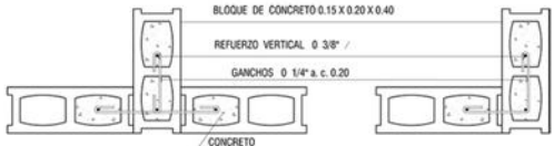
DETALLE DE UNIONES TÍPICAS DE PAREDES ESCALA : 1.10
