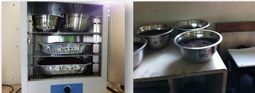
Figura 3.30 Ensayo de Contenido de humedad.
