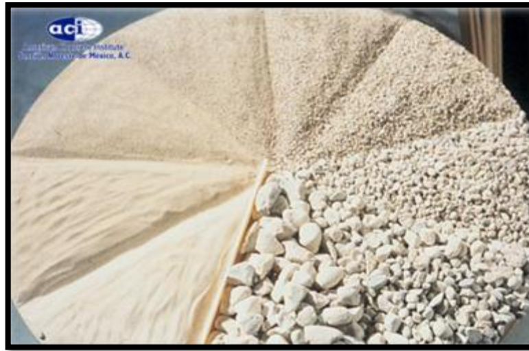
Figura 16: Agregados en el concreto. ( American Concrete Institute, ACI México ).
