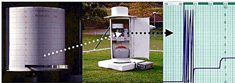
**Figura 3.2. Equipo pluviográfico con su respectiva banda de registro.**
