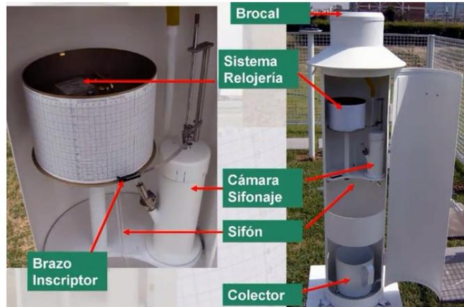
**Figura. 2.9. Pluviógrafo de Sifón.**
