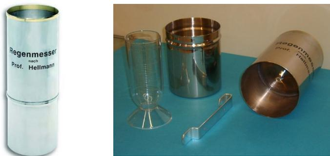
**Figura 2.8. Pluviómetro tipo Hellmann.**
