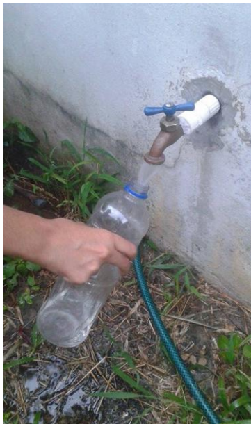
Fig. A4.2: Recolección muestra de agua potable
