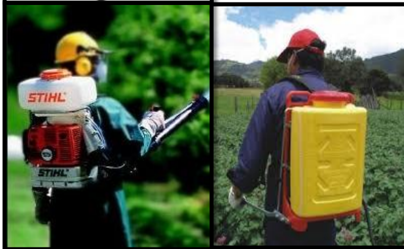
Imagen 32. Bombas motorizadas y bombas manuales.
