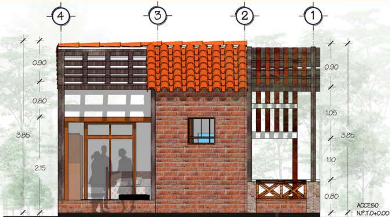
FACHADA LATERAL CABAÑA SENCILLA ESCALA:1:50
