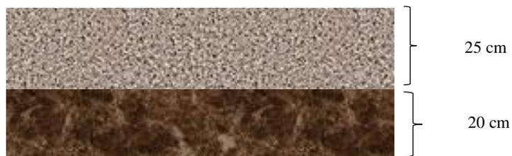
*Figura 42 Estructura de pavimento de concreto hidráulico*
