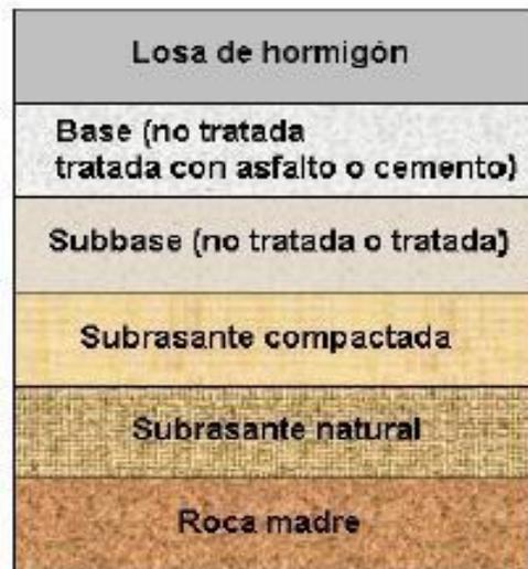
*Figura 28 Estructura de pavimentos de concreto hidráulico*
