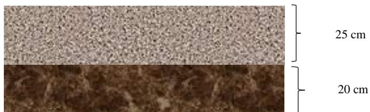
*Figura 39 Estructura de pavimento de concreto hidráulico*
