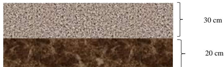
*Figura 37 Estructura de pavimento de concreto hidráulico*
