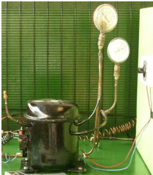
FIGURA 51 MANOMETROS DE ALTA Y BAJA PRESION.
