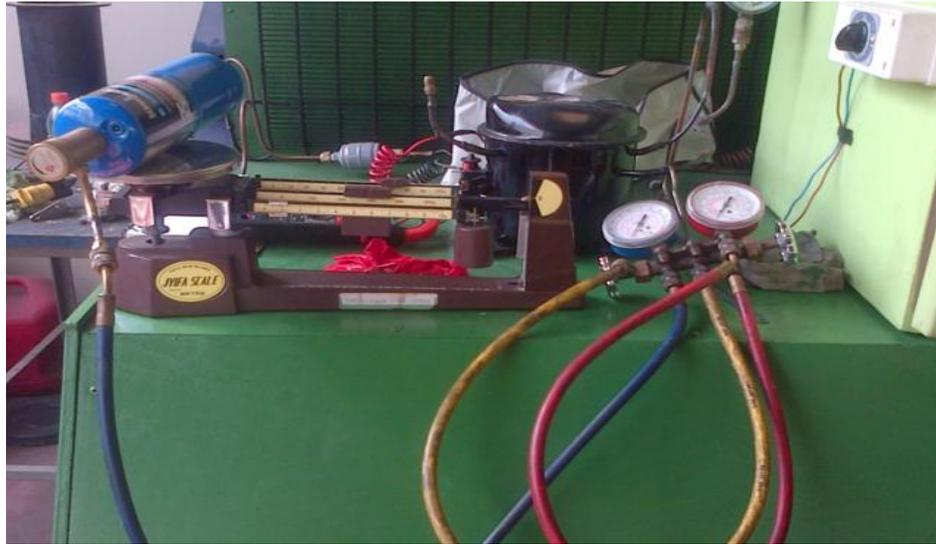
FIGURA 6. MEDICION DE LA MASA DE REFRIGERANTE CARGADO AL SISTEMA
