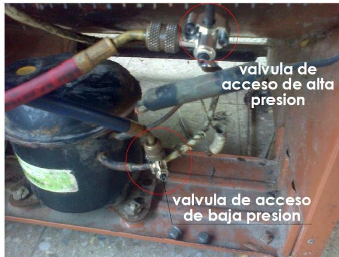
FIGURA 44. POSICION DE LAS VÁLVULAS DE ACCESO DE BAJA Y ALTA PRESIÓN
