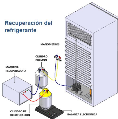
**FIGURA 1 DISPOSICION DEL EQUIPO DE RECUPERACION DE REFRIGERANTE**
