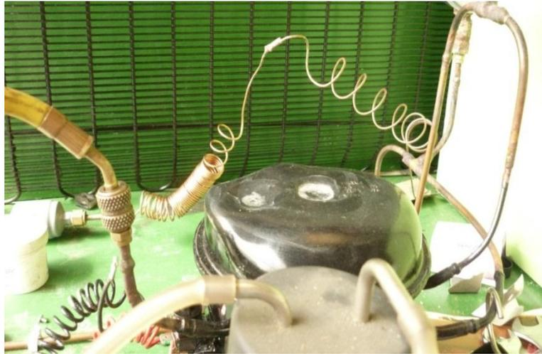
FIGURA 53 CAPILAR INSTALADO EN EL EQUIPO DE REFRIGERACION.
