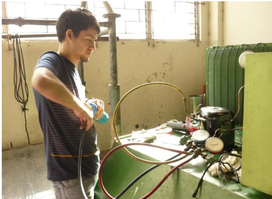
**FIGURA 58 CARGA DEL REFRIGERANTE R-290**
