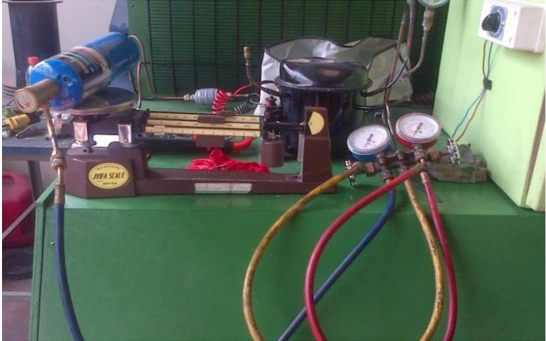
FIGURA 60. MEDICION DE LA MASA DE REFRIGERANTE CARGADO AL SISTEMA
