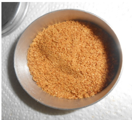
C) Muestra de la galleta triturada después de determinación de humedad
