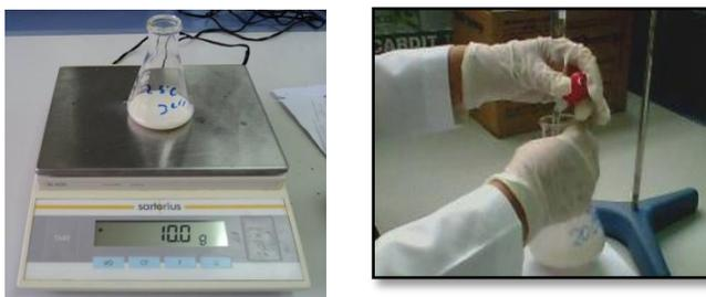
**Figura N°7:** Proceso de valoración para la obtención del valor de acidez titulable.
