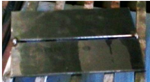
Fig. 2.6. Placas unidas mediante puntos de soldadura antes de iniciar el proceso de soldadura.
