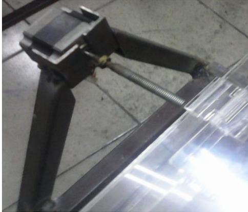
**Figura 2.24.** Motor paso a paso Unipolar con varilla roscada en el eje
