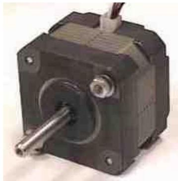
**Figura 1.15.** Motor paso a paso
