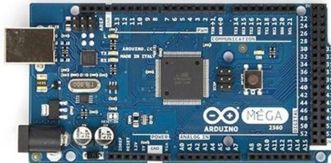
**Figura 4.02.**Placa Arduino Mega 2560
