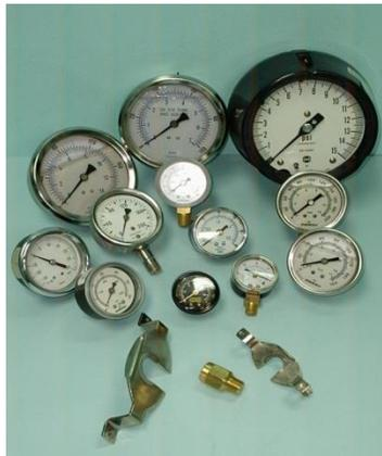
**Figura 1.10.** Diferentes tipos de manómetros
