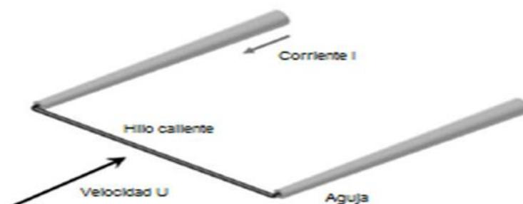
Figura 3.01. Elemento Térmico frente a flujo de un fluido
