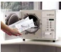
El autoclave debe llevarse a cabo en un sistema de esterilización a presión de vapor con un ciclo estándar que oscile entre los 134<sup>a</sup> (+4/- 0) <sup>a</sup>C/273<sup>a</sup>F durante 3 minutos.
