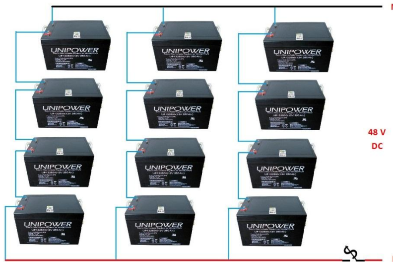
Ilustración 4. ARREGLO DE BATERIAS DEL SISTEMA FOTOVOLTAICO AISLADO
