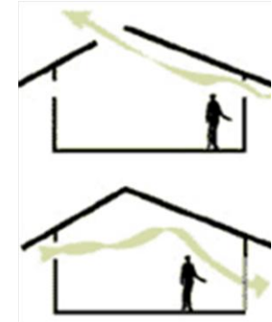
Figura 93 Formas para lograr ventilación cruzada. Fuente: portal web universidad de venezuela FAU
