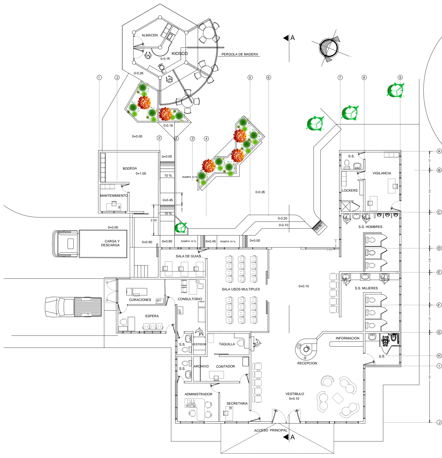
PLANTA ARQUITECTONICA Esc. 1:150
