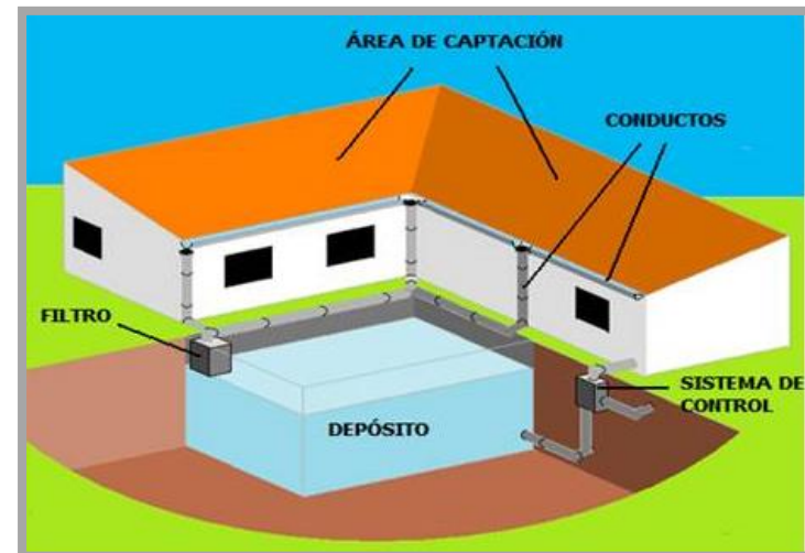
FOTO 76: Sistema de captación de aguas lluvias.
