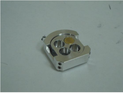
Fig. 30. Aditamento para colocar las muestras dentro del microscopio.
