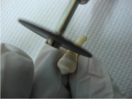
Fig. 24. Corte de las piezas con discos de carburo de silicio.
